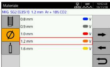
Impostazione del filo di apporto con indicazione del tipo di rullini
