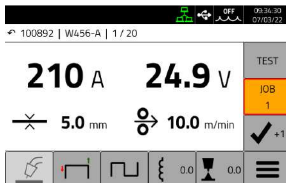
Screenshot del pannello di controllo della saldatrice
