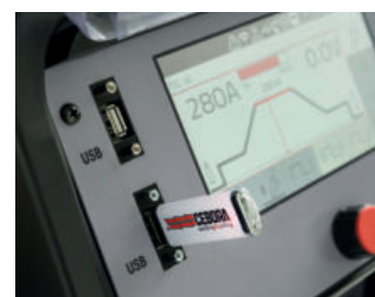
2 porte USB per il salvataggio dei dati e per aggiornare il software 2 USB ports for saving data and updating software
