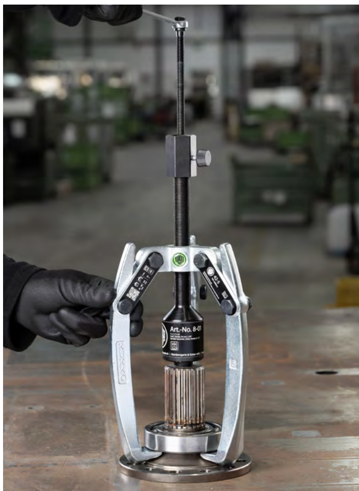
Smontaggio cuscinetti a sfera da una flangia dell'albero di trasmissione con mandrino idraulico.
