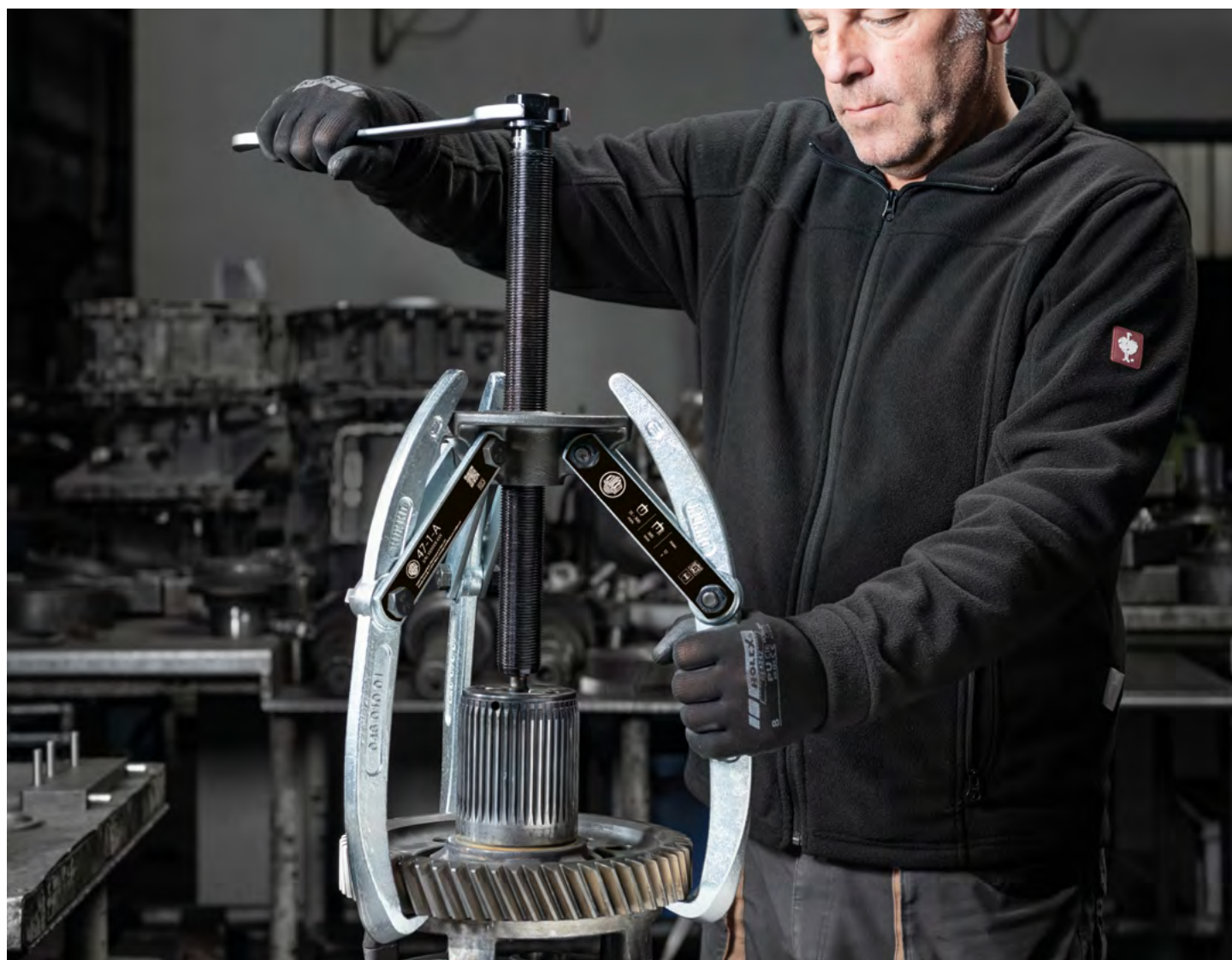
Estrarre una ruota dentata con il 47-1-A.
