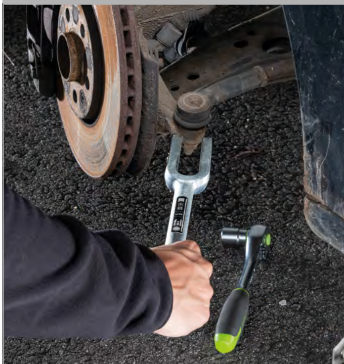
Separato di un braccio oscillante dalla sospensione della ruota
