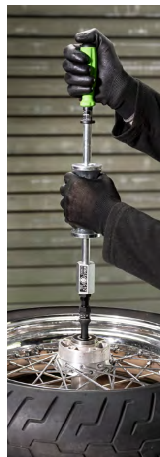
Estrattore interno della serie 21 con controsupporti.
