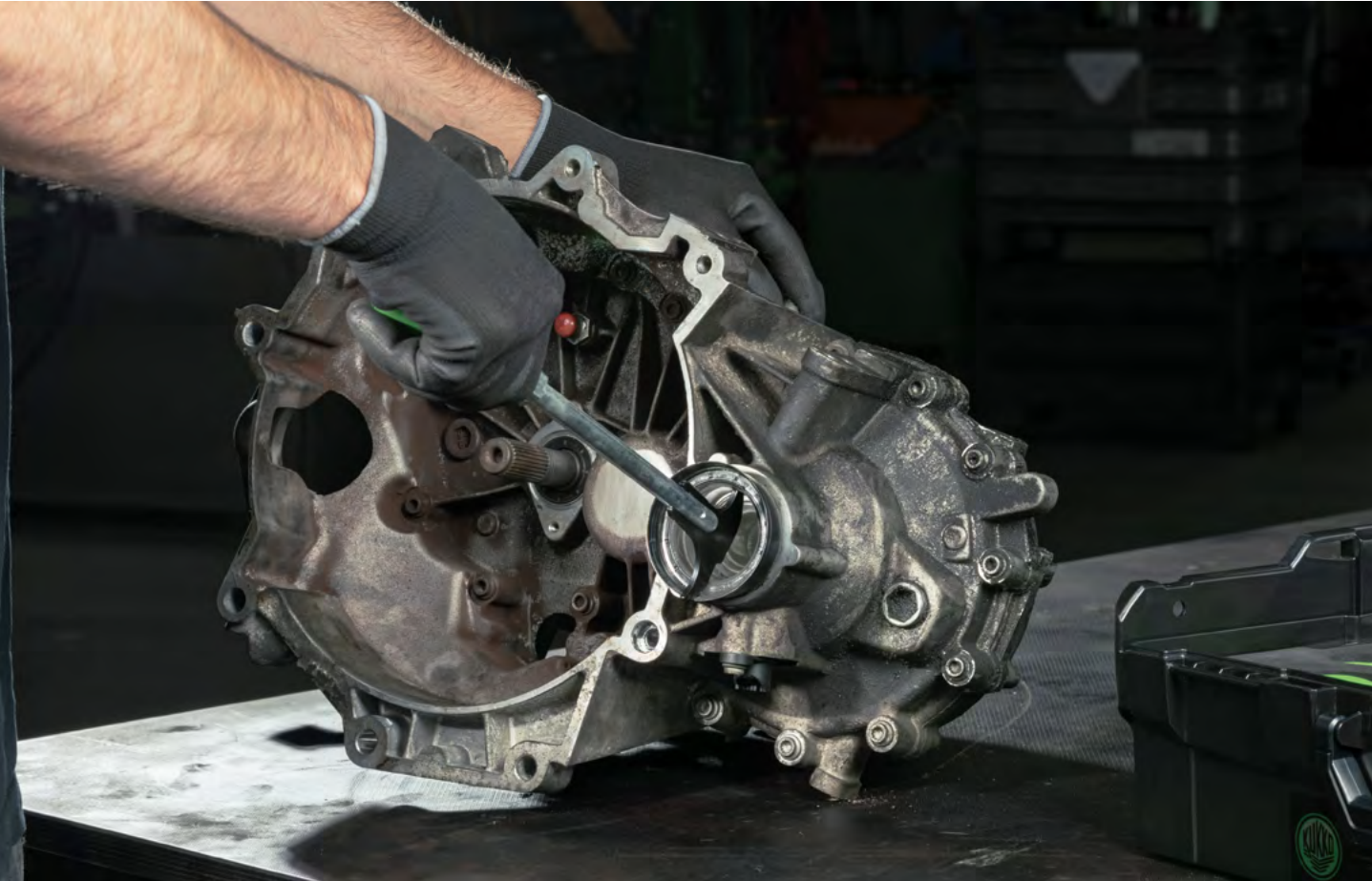
Smontaggio di un anello di tenuta con il 222-U.
