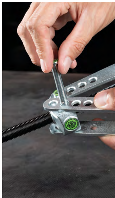
I bracci estrattori sono regolati e il perno di sicurezza viene inserito.
