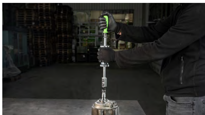
Estrazione di un cuscinetto a sfera con estrattore a battente e un estrattore interno della serie 21.
