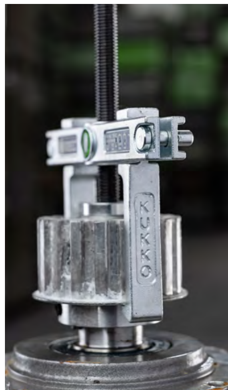
Il perno di sicurezza è stato inserito.
