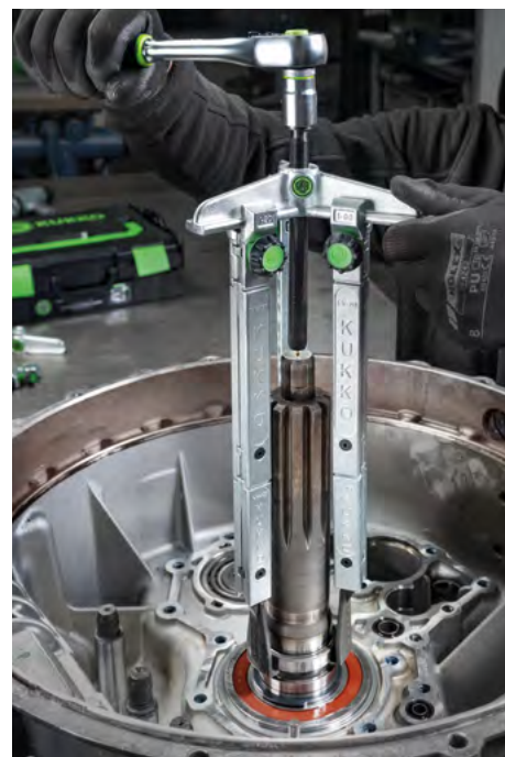
Estrattore a 3 bracci con gancio di estrazione stretto e allungato per la rimozione di un cuscinetto a sfera.
