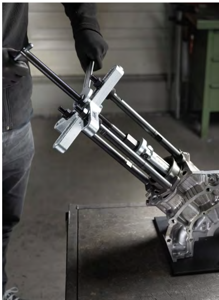
Con tre bulloni a piedi sulla traversa, si ha una posizione ottimale durante l'estrazione con l'estrattore per boccole cilindriche 16-2.
