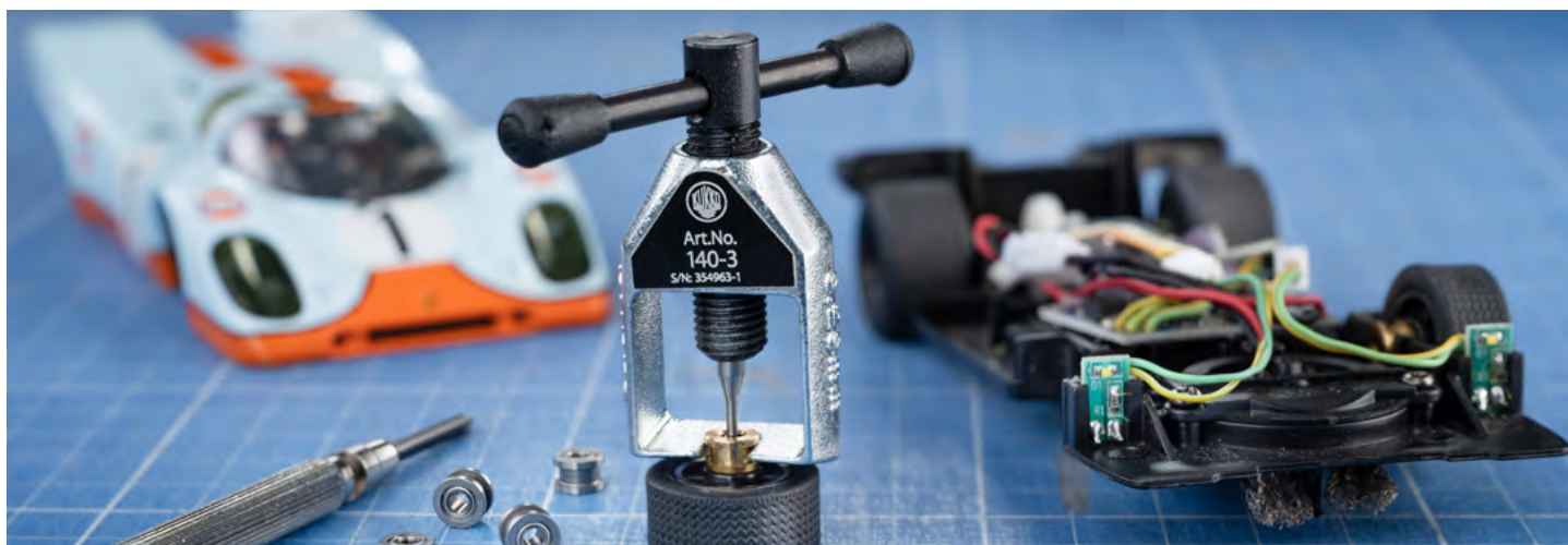
Estrazione di un cuscinetti a sfera su una ruota di un modellino d'auto con il 140-3.
