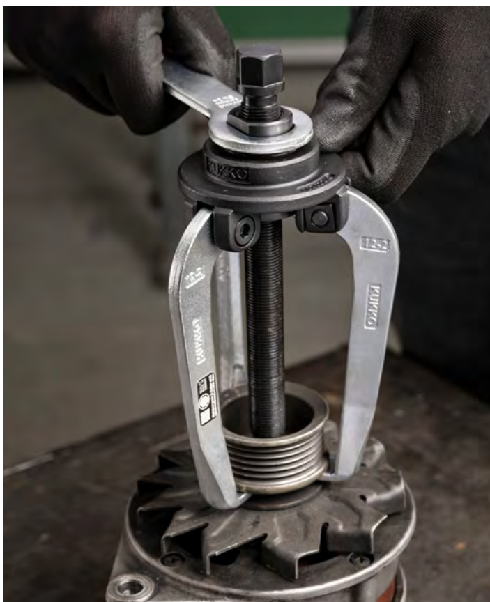
Rimozione di una puleggia da un generatore di automobile.
