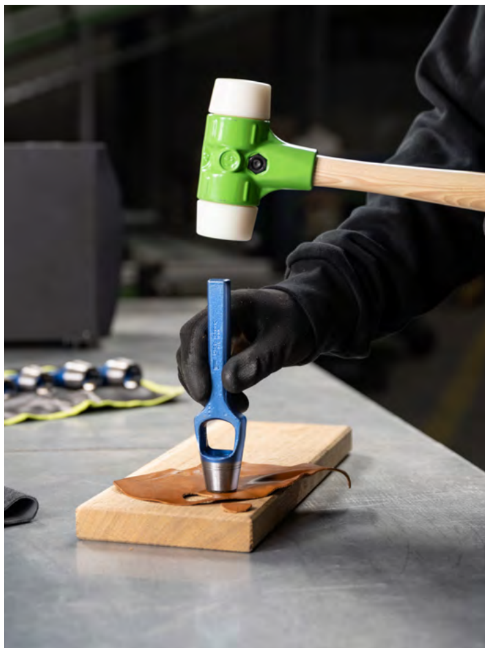
Un ferro Henkelloche della serie 326 viene utilizzato insieme a un mazzuolo a faccia morbida di KUKKO.
