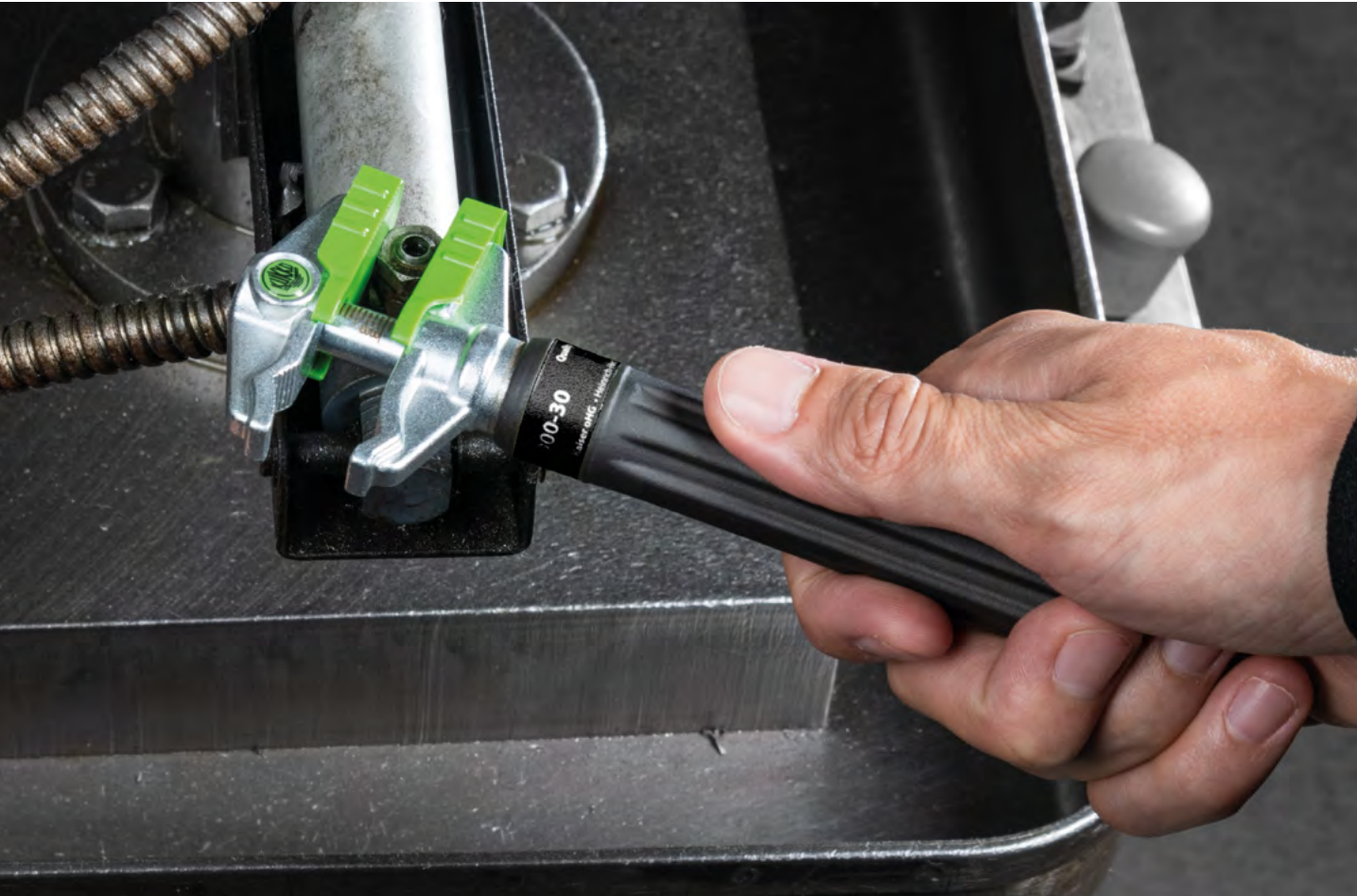
Rimozione di un dado con Europäer 1900-30.
