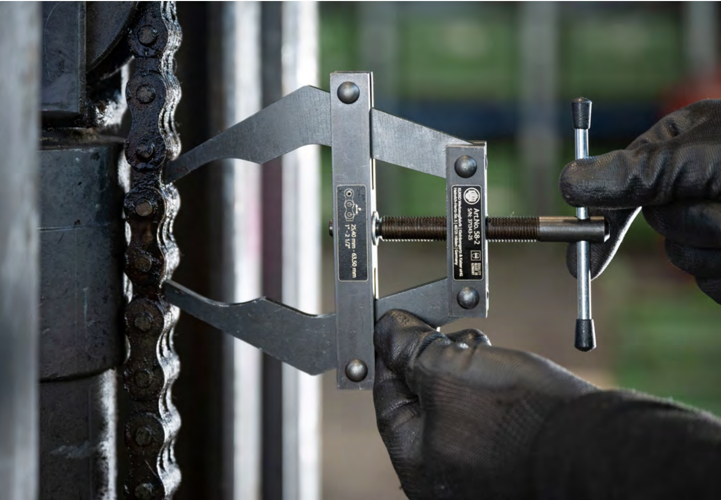
Con il tenditore per il montaggio 58-2, la catena di sollevamento di un carrello elevatore viene tesa per facilitarne il smontaggio.
