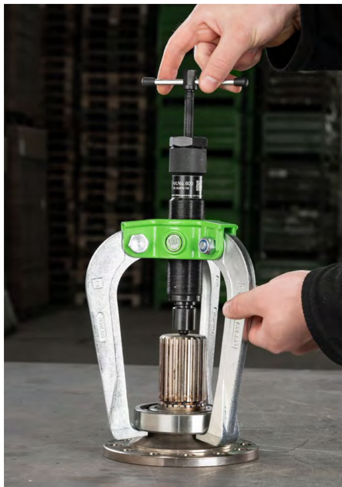
Azionamento dell'impugnatura a T per generare la forza idraulica.
