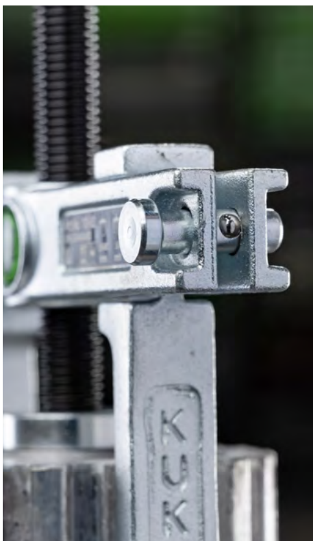
La sfera con molla fissa il perno per evitare lo sfilamento.
