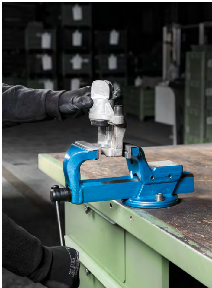
Il serraggio di un pezzo con una morsa della serie 525.
