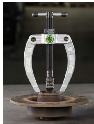
Estrattore interno della serie 21-E con controsupporti.
