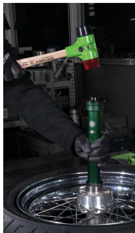
Installazione del cuscinetto con il 71-L.
