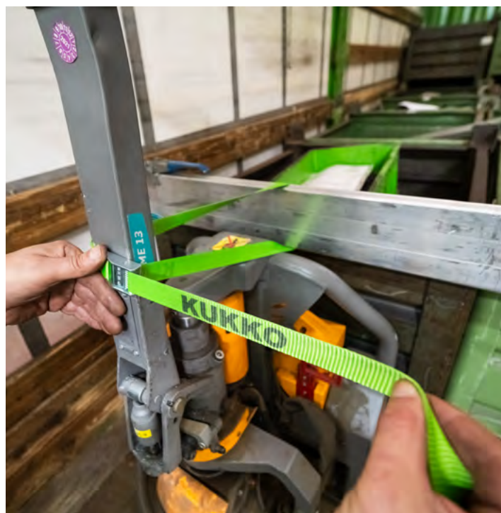
Fissaggio del carico con cinghie di tensione KUKKO.
