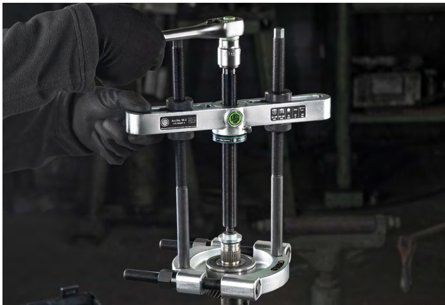
La dispositivo di separazione 15-2 durante l'estrarre di un ingranaggio bloccato su un componente della macchina.
