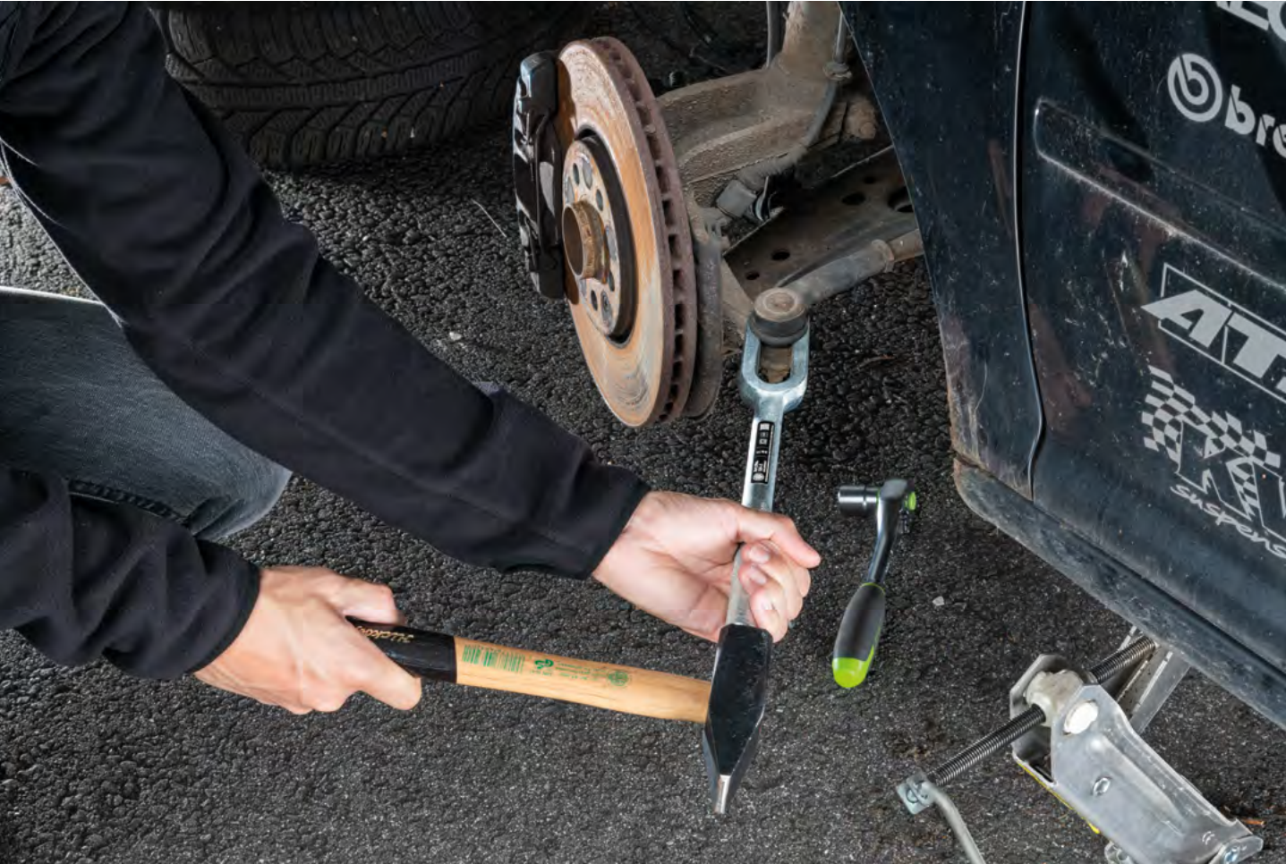
La forcella separatrice 135-2 per rimuovere un giunto sferico incastrato nel sedile conico di un'auto.
