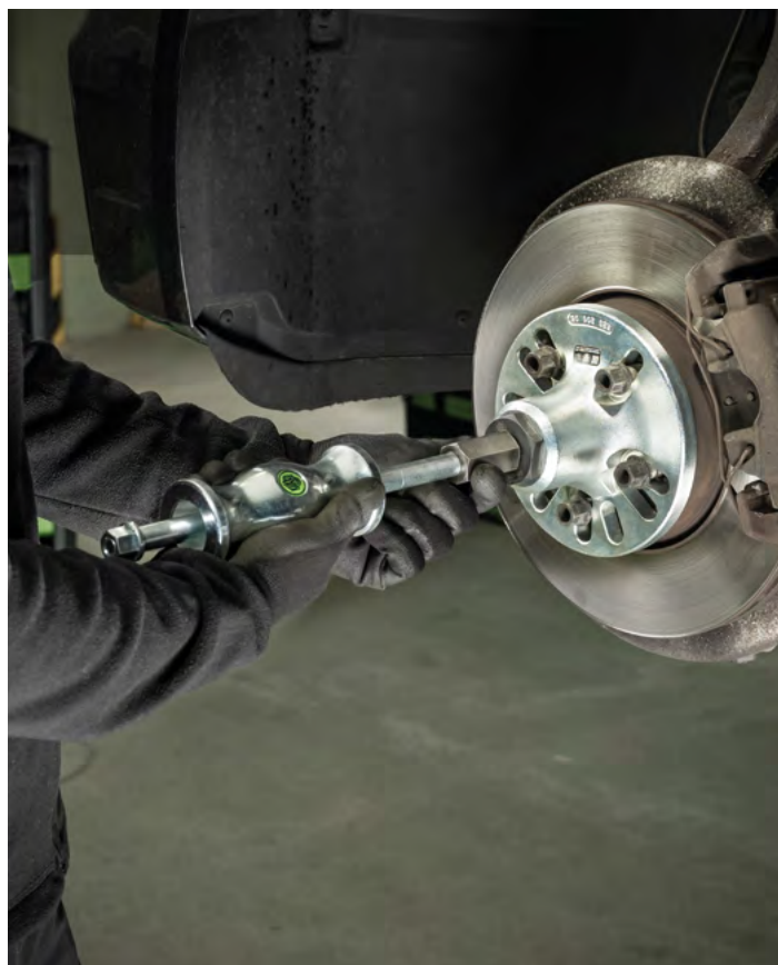
L'estrattore mozzo 229-1-1 con estrattore a battente per l'estrazione dei mozzi delle ruote bloccati da una vettura.
