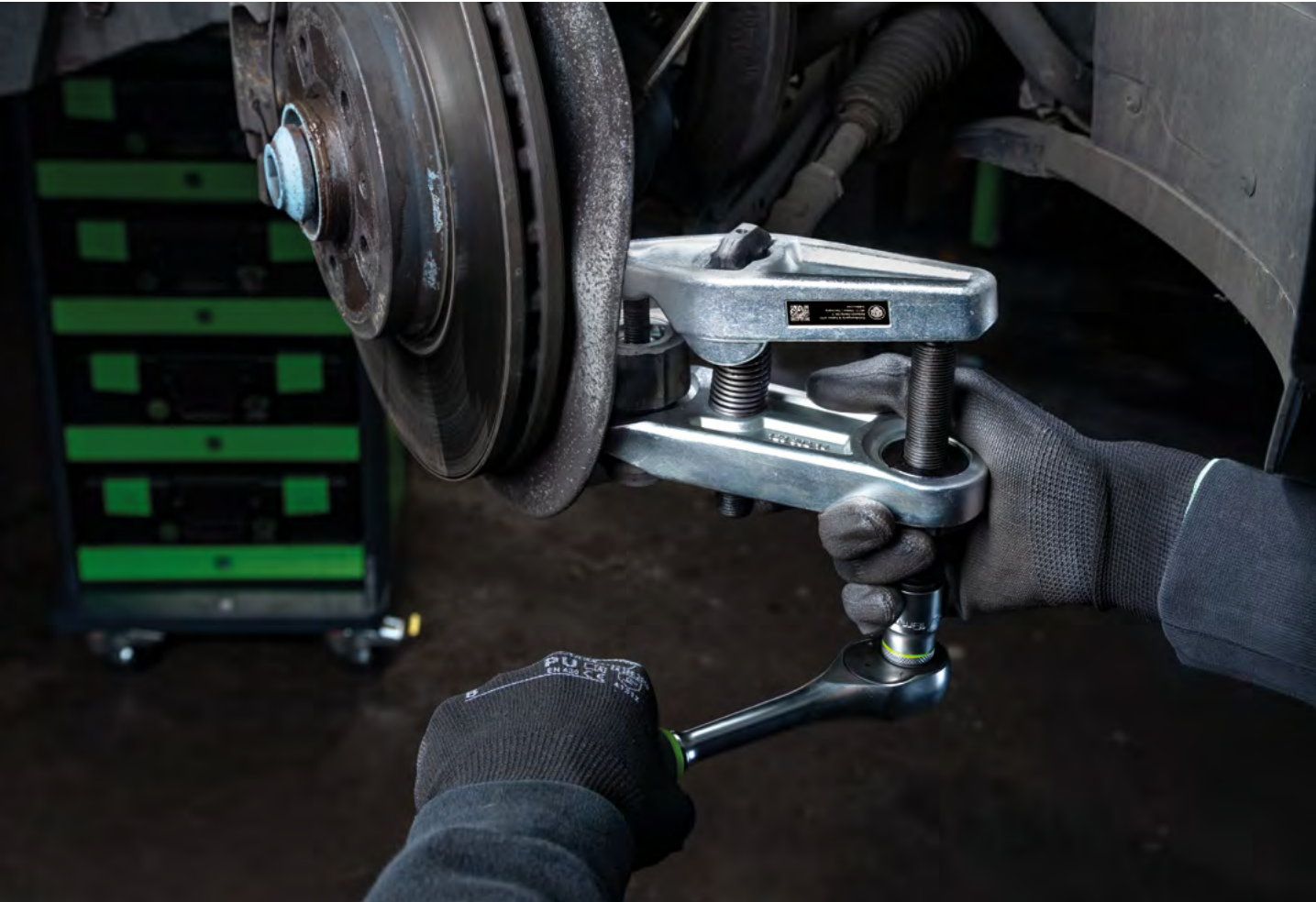
L'estrattore per snodi sferici 129-3 durante l'estrazione di un bottone della barra di collegamento dello sterzo.
