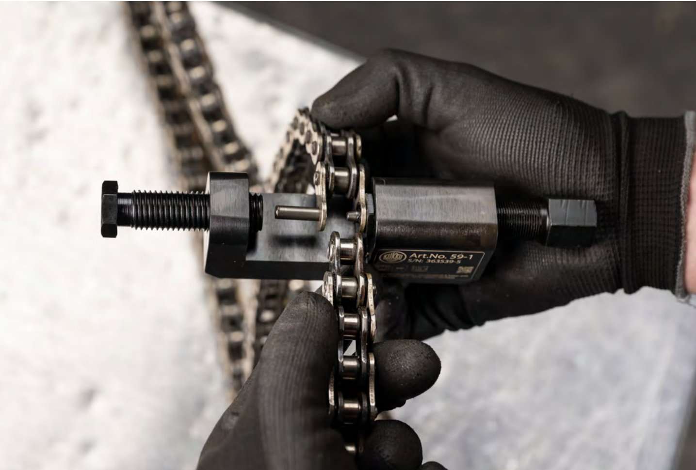
Con il Kettensprenger 59-1 è stato espulso il perno di una catena.
