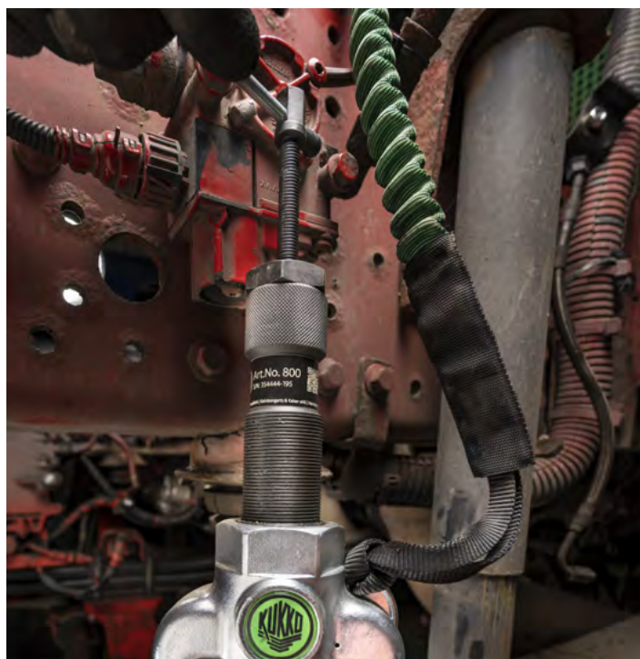
La caduta sicura assicura l'estrattore per giunti sferici.
