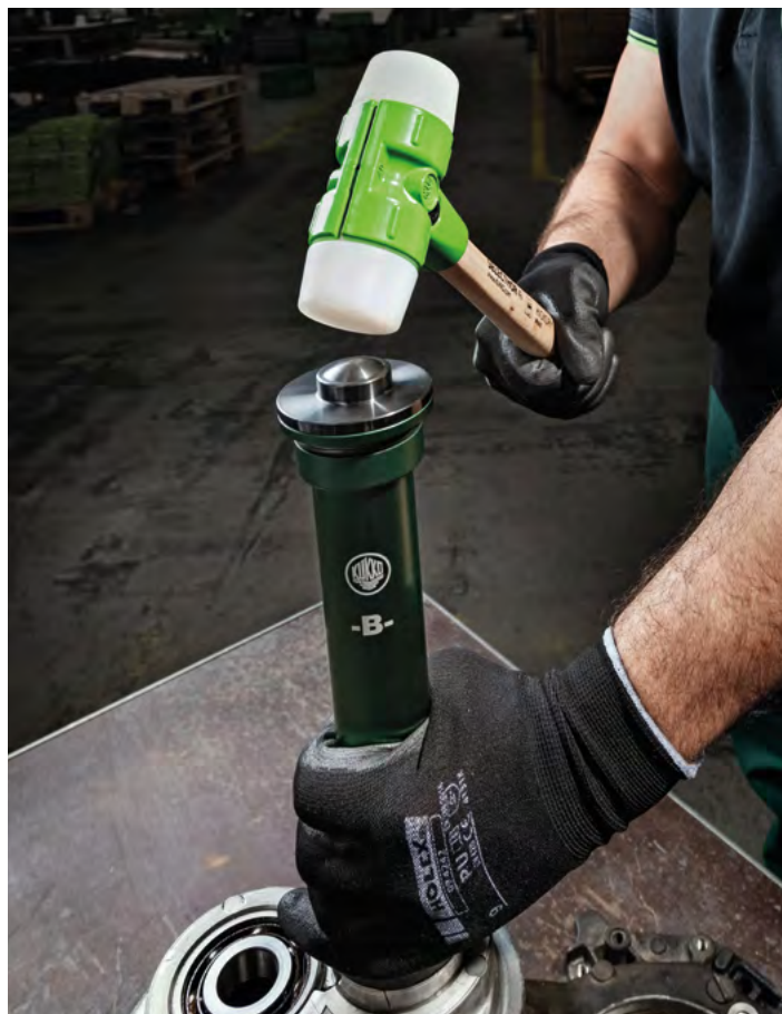
Installazione di un supporto del cambio con una mazzuola Selecthor in combinazione con il 71-L
