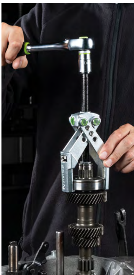
Estrarre un cuscinetti a sfera da un albero di trasmissione.
