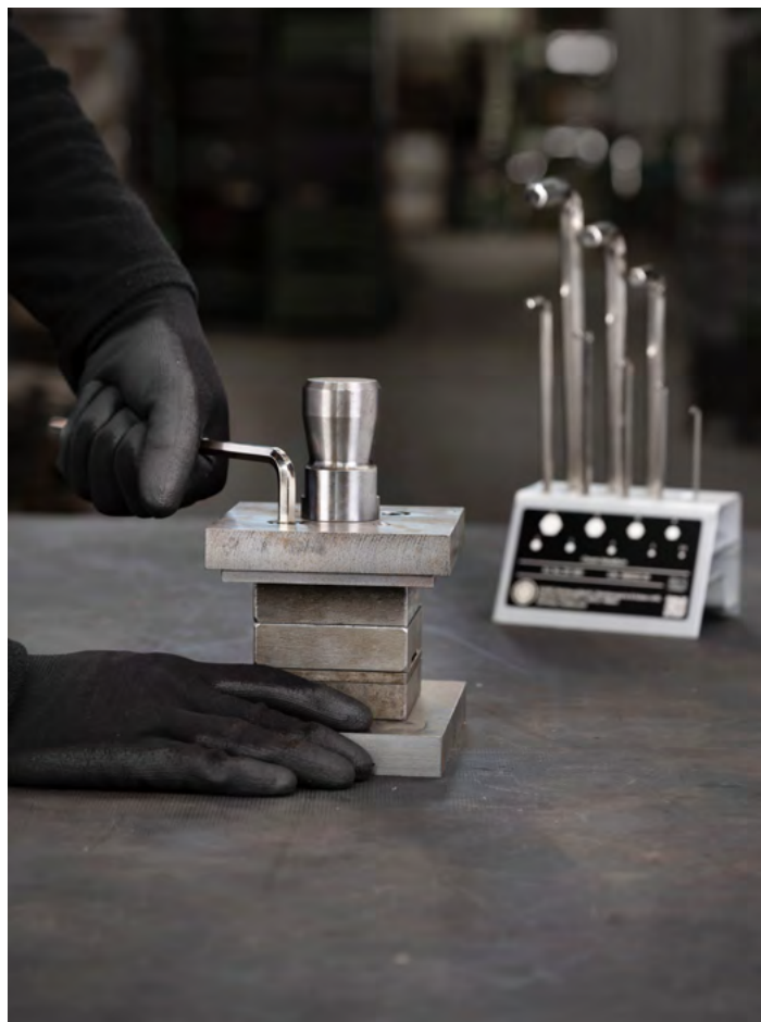
I cacciaviti esagonali maschio del supporto per vendita e officina ISO 2936 durante il demontaggio di un fustella.
