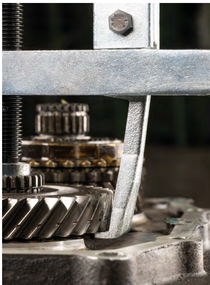
Vista dettagliata della forma speciale del gancio.
