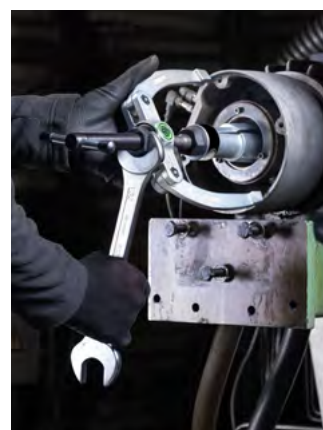
Estrattore interno serie 21 con controsupporti.
