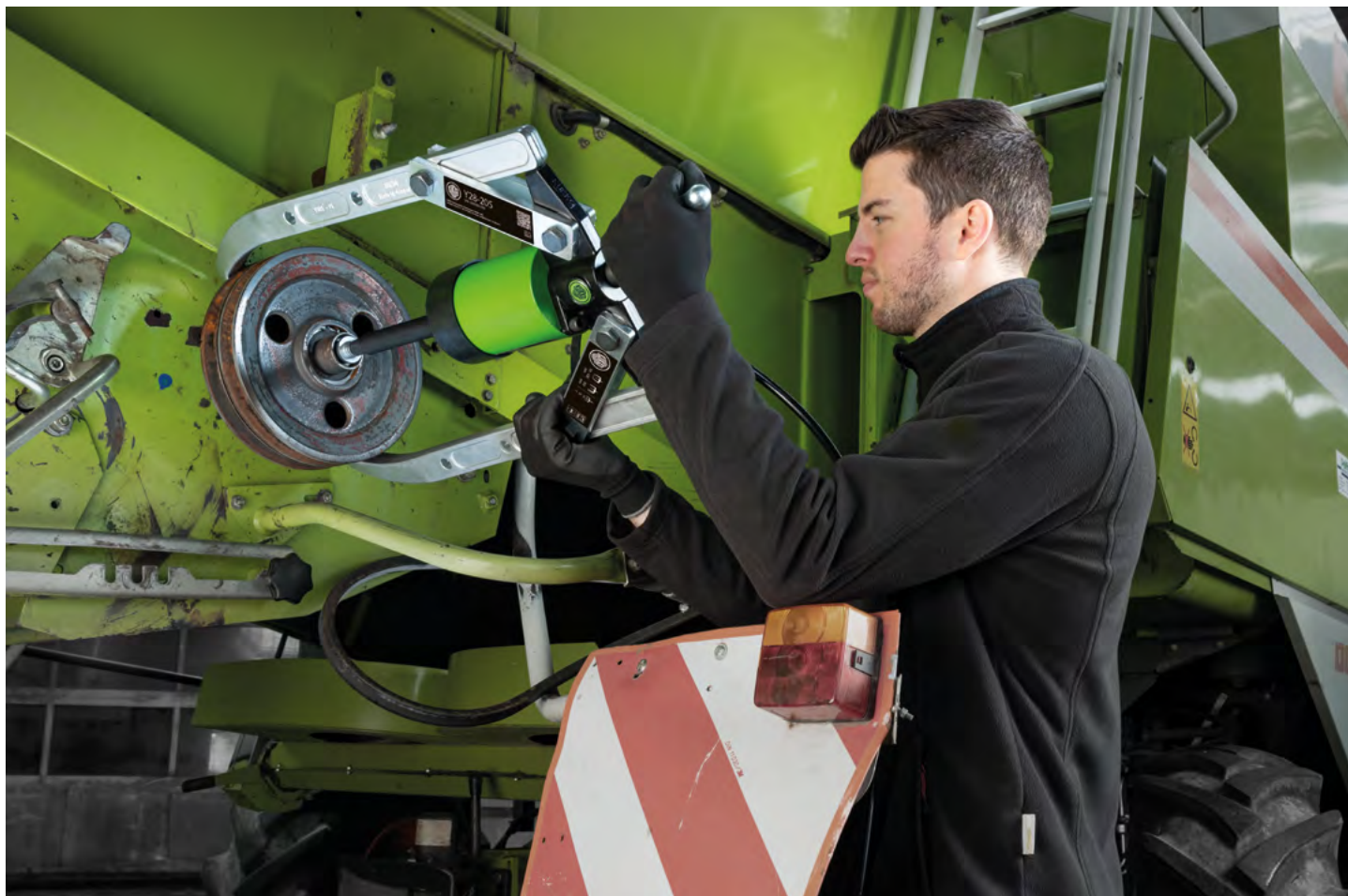
Estrazione esterna di una puleggia da una mietitrebbia con l'estrattore idraulico Y28-205.
