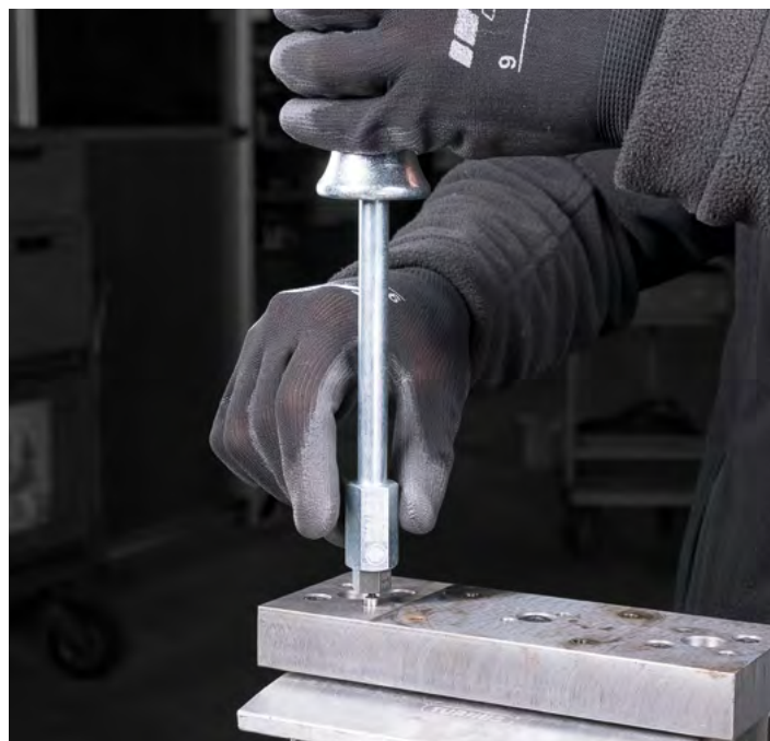
Estrazione di un cuscinetti a sfera mediante estrattore a battente, dado di collegamento e adattatore filettato.
