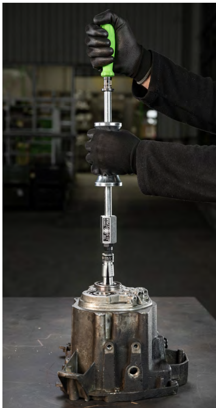
Estrazione interna di un cuscinetto a sfera con il 21-4 e un estrattore a battente.
