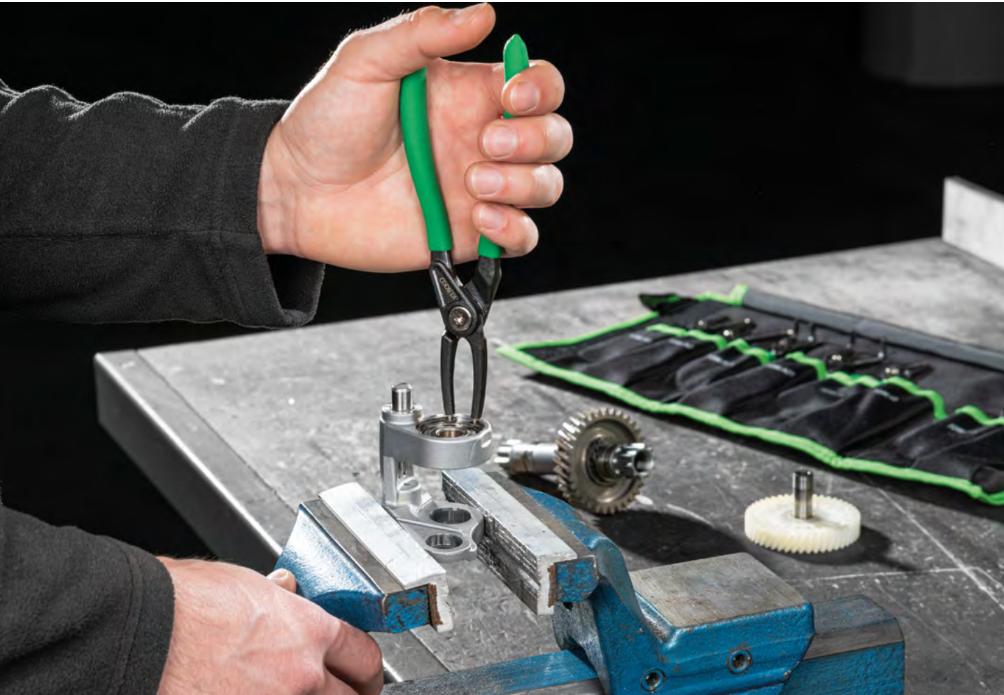
Una pinza per anelli di sicurezza dal set di pinze per anelli di sicurezza 728K-729 viene utilizzata per rimuovere un anello di sicurezza bloccato.
