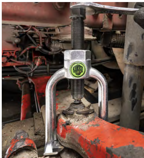
Il estrattore per giunti sferici 128-60 durante l'estrazione di un giunto della barra di sterzo in un'officina.
