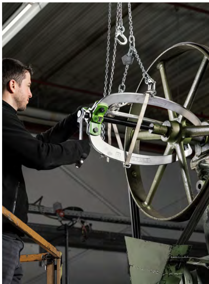
Una cintura di fissaggio aggiuntiva fissa il braccio estrattore.
