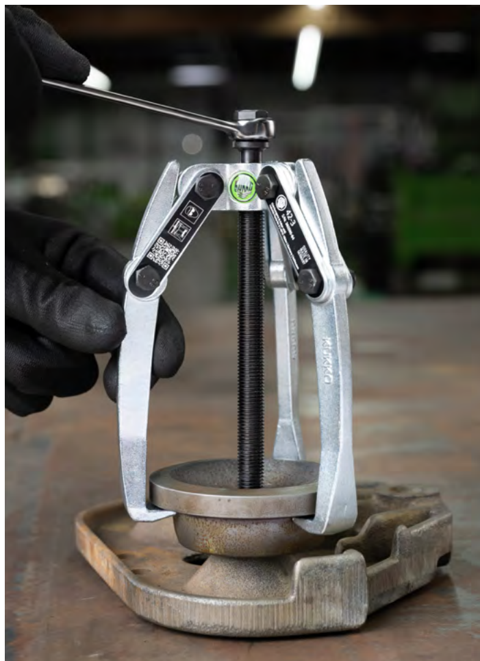
Smontaggio di una puleggia da una parte di una macchina con il 42-3.
