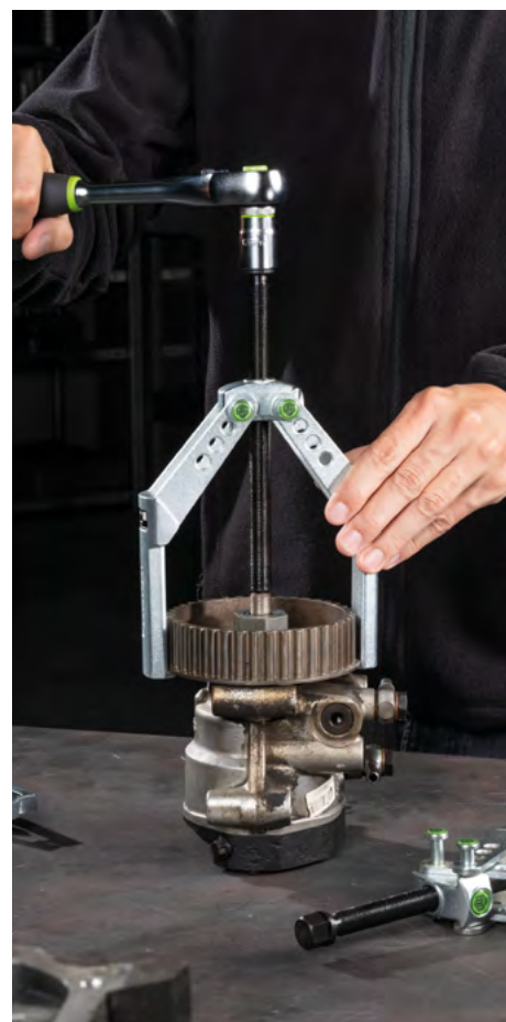
L'eliminazione della sovrapposizione dei bracci estrattori aumenta la capacità di serraggio di molte volte.
