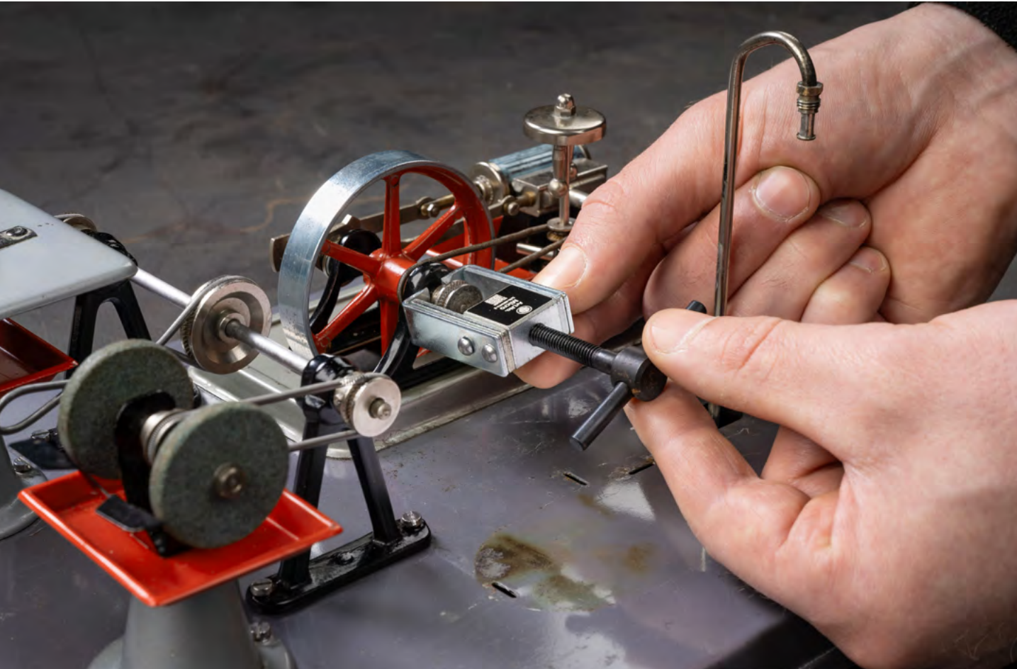
Estrarre una puleggia da una mini macchina a vapore.
