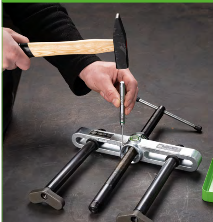
Estrazione di un perno di sicurezza con un cacciaspine
