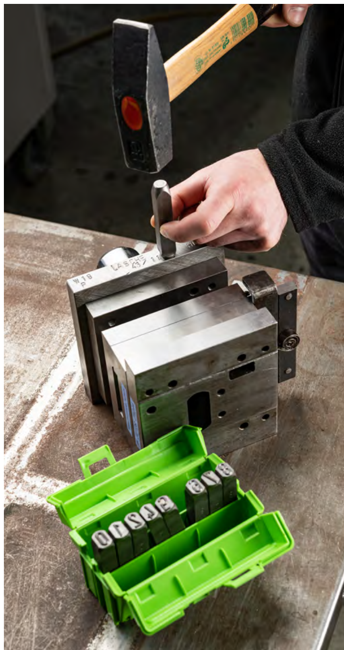
Marcatura di una fustella con punzoni con numeri della serie 328.
