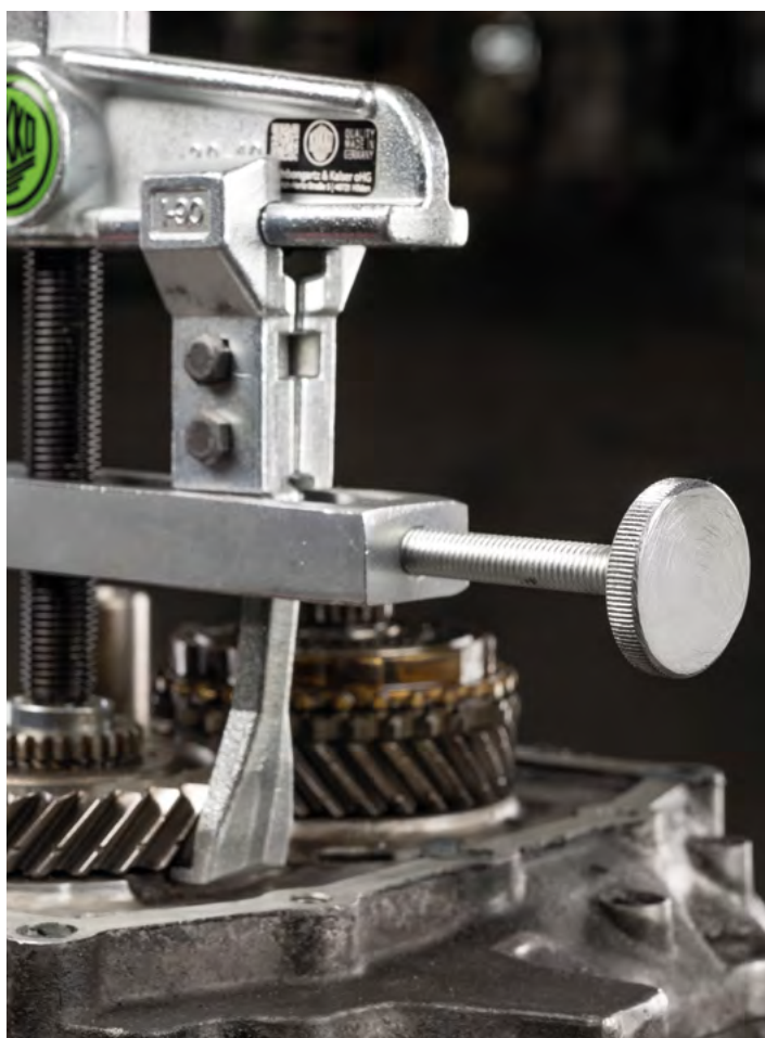
La morsa pressa le griffe di estrazione contro la parte da estrarre.
