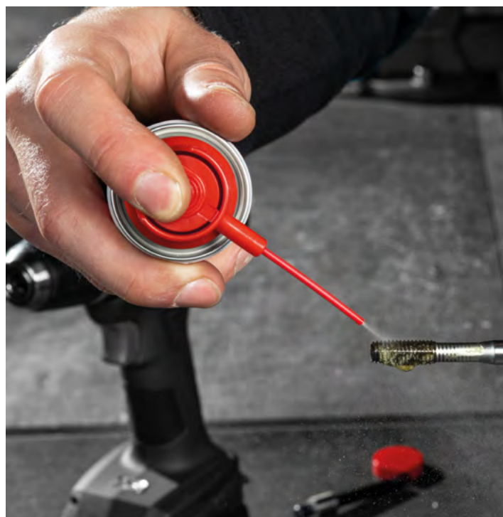
Lubrificazione della filettatura.
