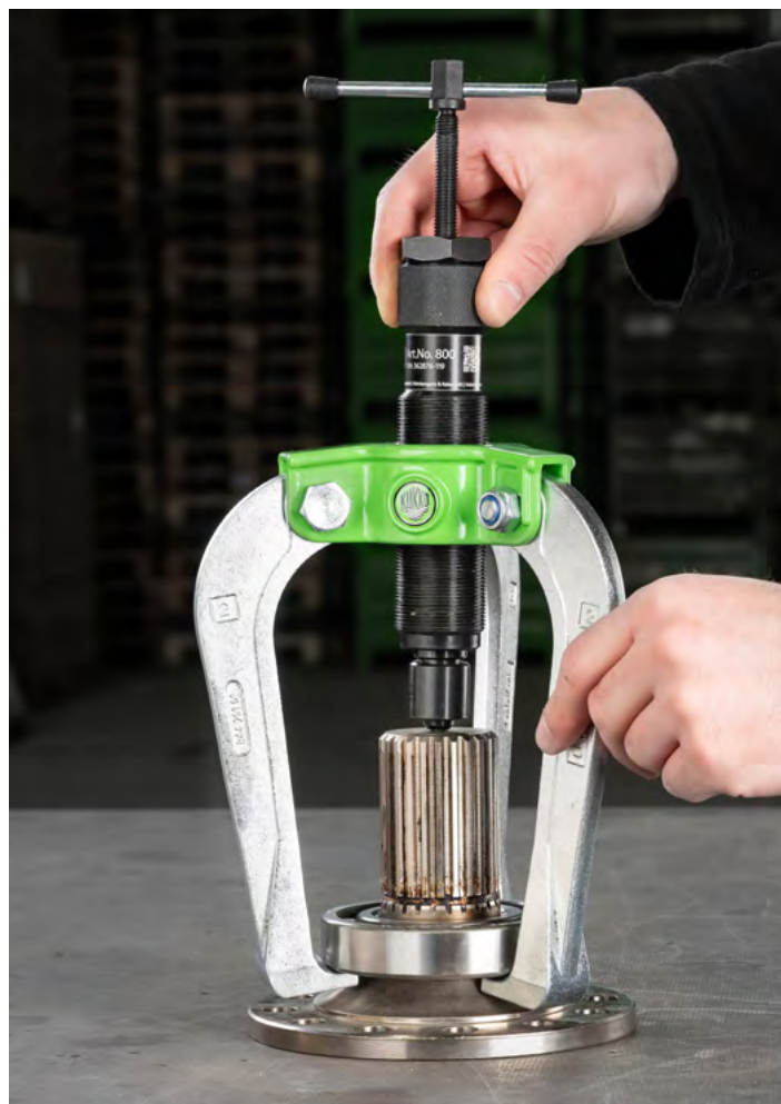
Tendere l'estrattore avvitando il mandrino idraulico alla zigrinatura.
