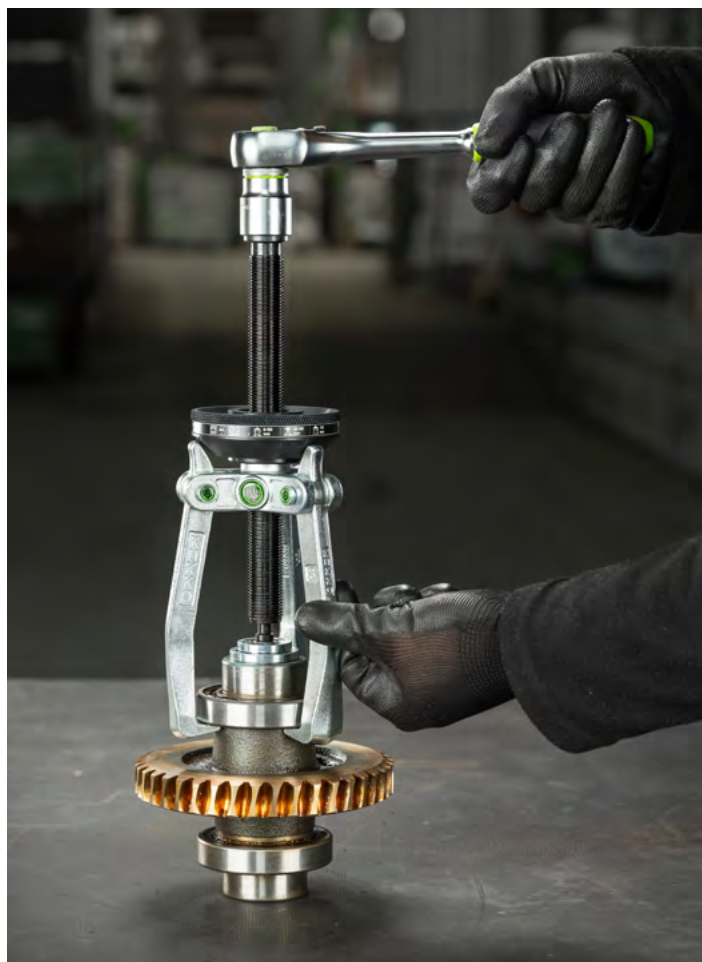
Estrazione esterna di un cuscinetto a sfere da un albero di trasmissione.
