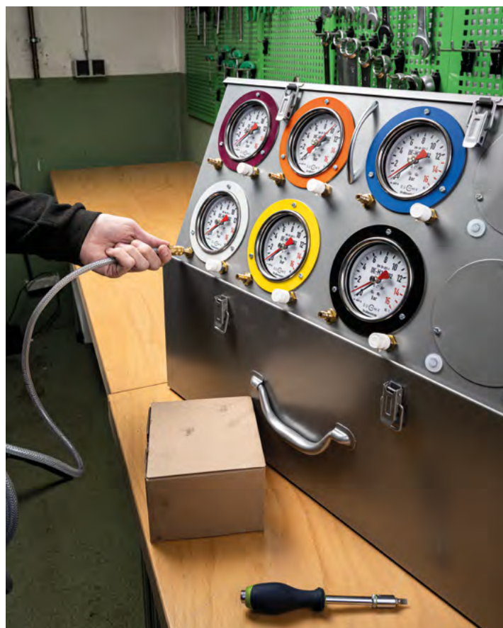
Collegamento di un tubo pNuovomatico al raccordo della frizione.
