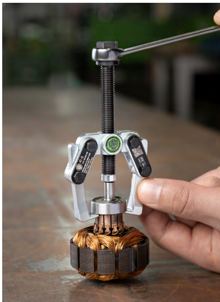
Estrazione di un piccolo cuscinetti a sfera da una E-Motor-Welle con il 41-0.
