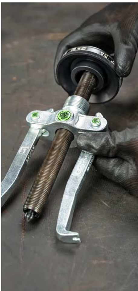
Montaggio del cono di serraggio ruotato di 180°.
