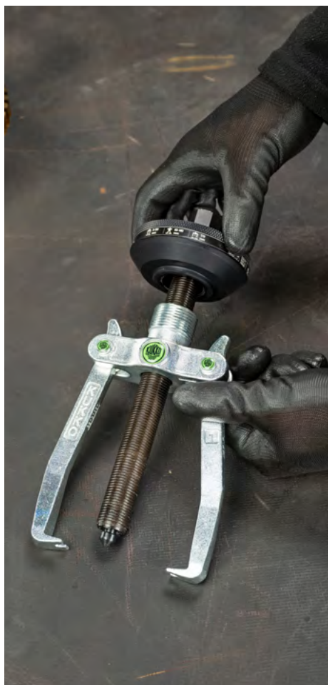
Rimozione del cono di serraggio.
