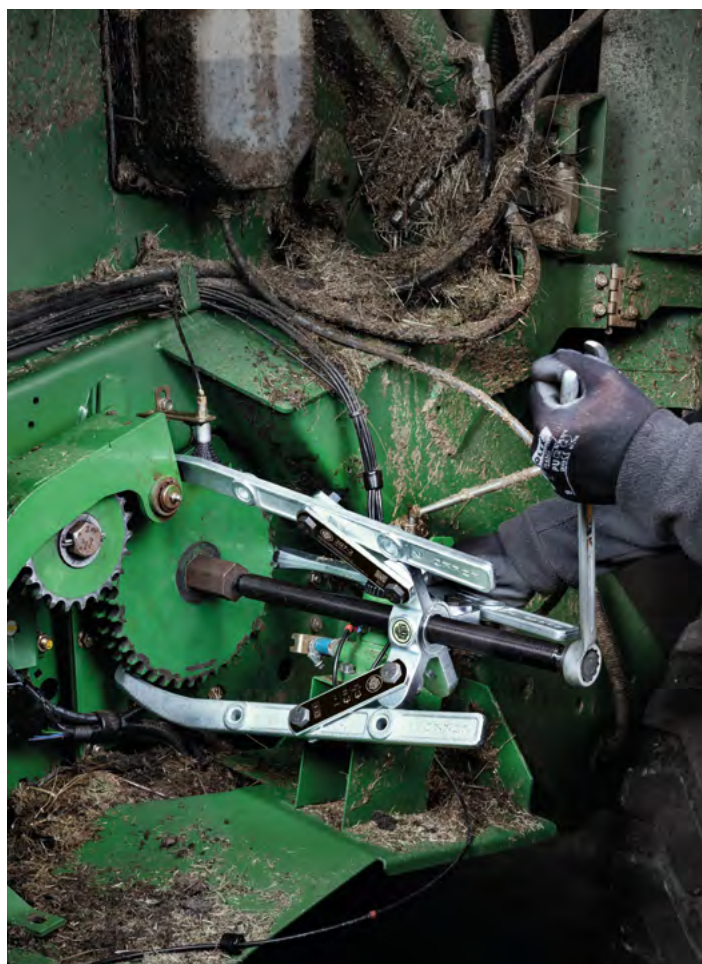
Estrazione di un ingranaggio con l'estrattore pesante a linguetta 207-2.
