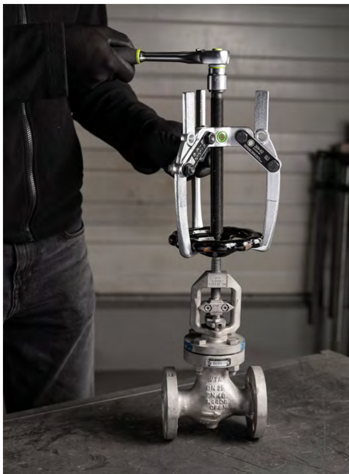
Estrarre il volantino da una valvola di intercettazione con il 209-02.
