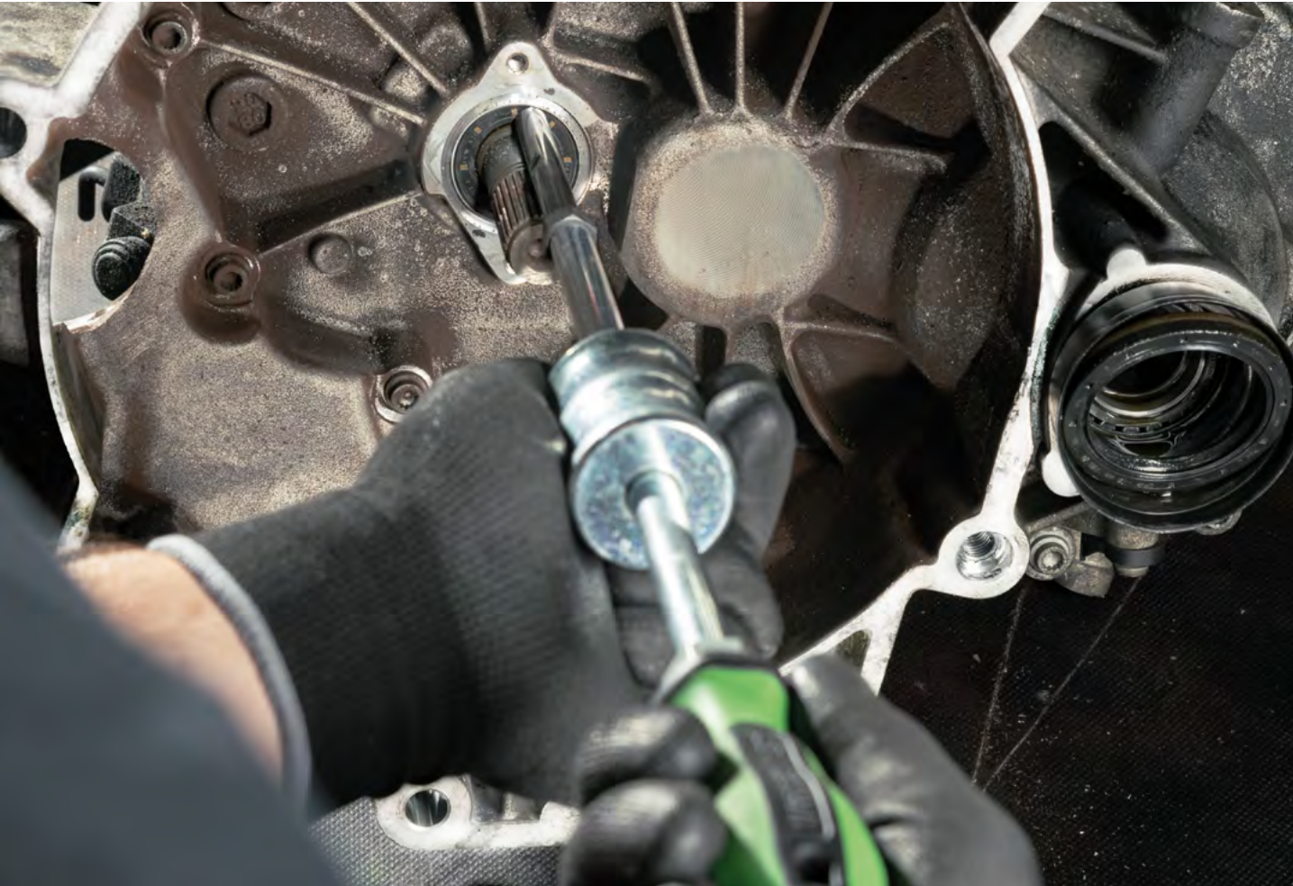
Rimozione di un anello di tenuta radiale con il 222-1.
