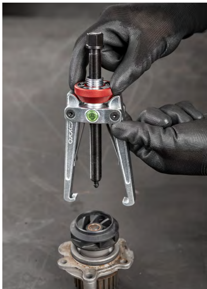
L'estrattore a 2 bracci per cuscinetti a sfera 112-20 con zigrino conico durante l'estrazione di un cuscinetti a sfera su una pompa dell'acqua.
