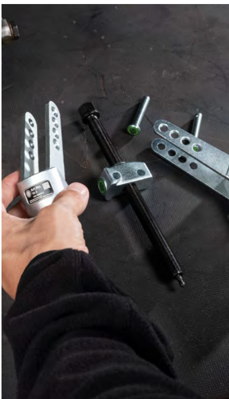
Nuovo assemblaggio delle singole parti e inversione dei bracci estrattori.
