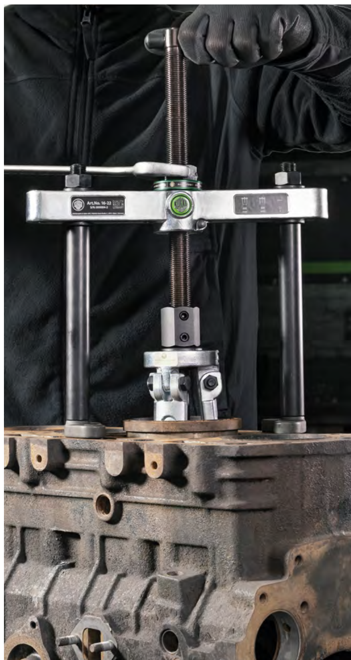
Estrazione di una bocca cilindrica con il 21-90 e il controspunto 22-5.
