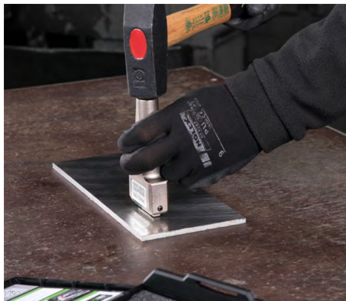
Marcatura di una lastra d'acciaio con un punzone manuale della serie 333.
