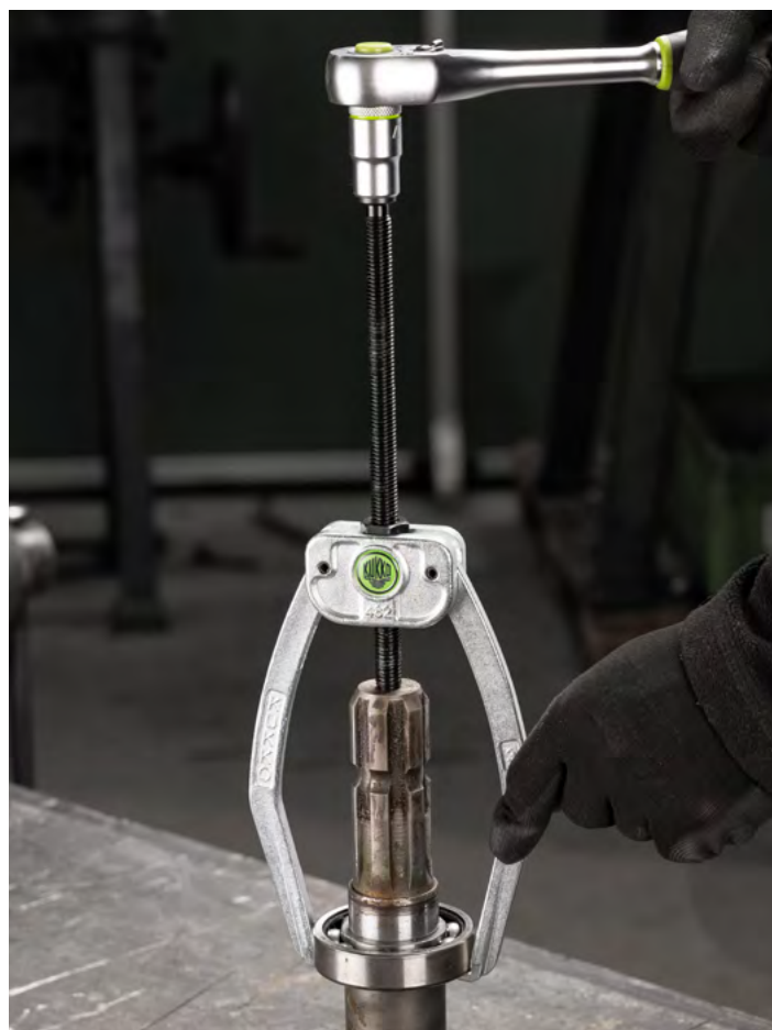
Smontaggio di un cuscinetti a sfera da una ruota dentata del cambio.
