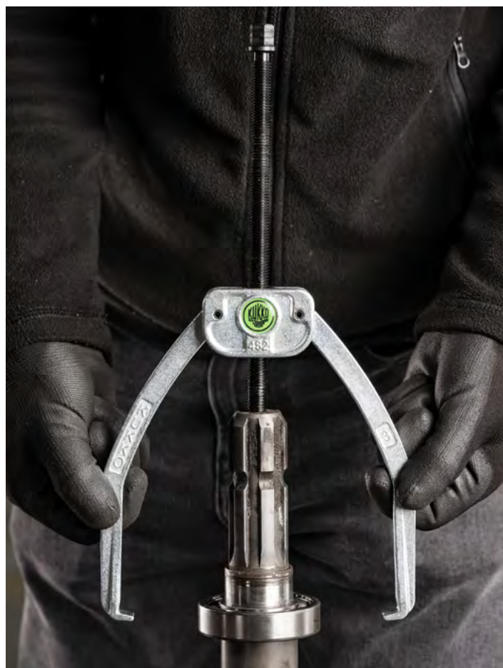
Installazione dei bracci estrattori sul componente da smontare.
