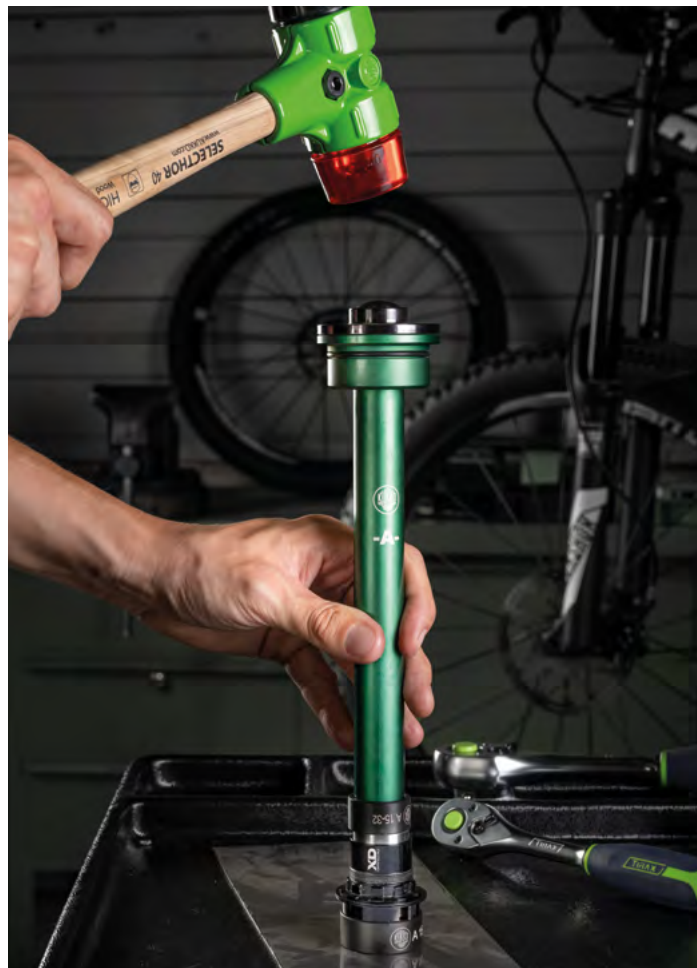
Inserimento di un cuscinetto utilizzando un K-71.
