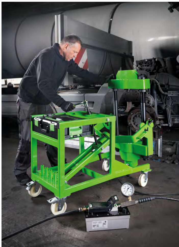
La pressa idraulica per perni fuso "AXLE" Y-AP-75 viene regolata con un cricchetto.
