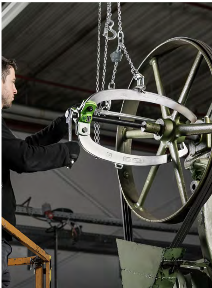
Estrazione di una puleggia con il 45-8 con mandrino meccanico. L'estrattore è collegato a URANUS per il bloccaggio e il mantenimento.
