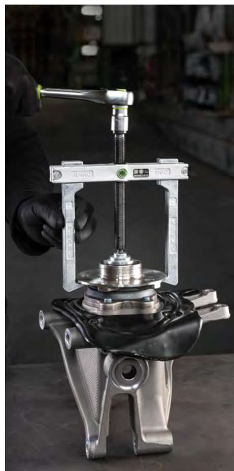
Estrarre un mozzo della ruota da un fuso a snodo con il 110-2.
