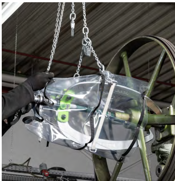
La copertura protettiva garantisce un estrarre sicuro.
