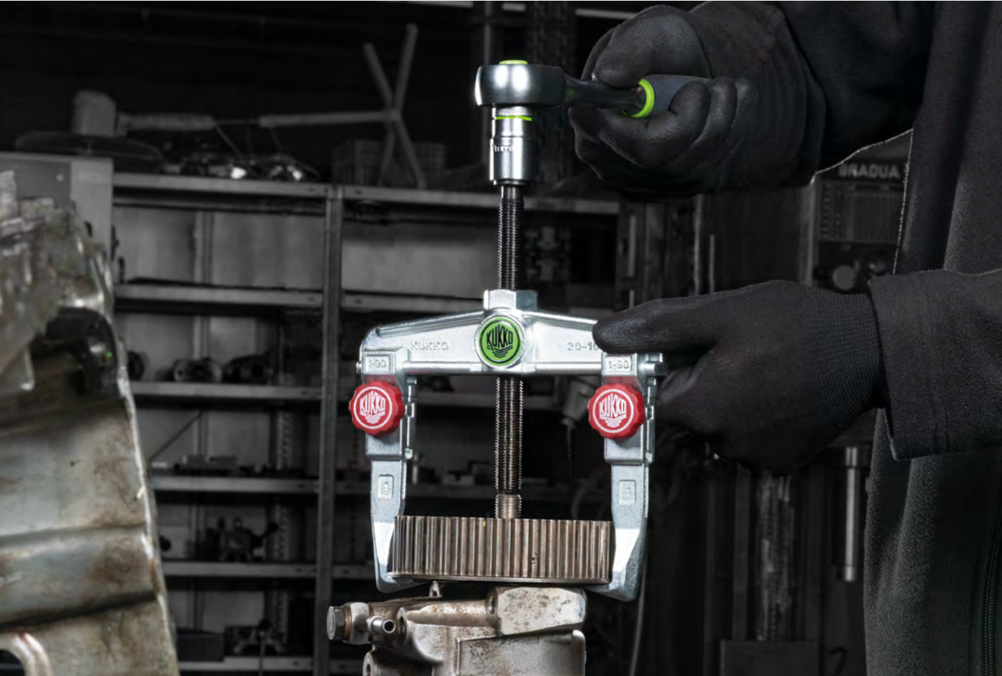
Rimozione di una ruota dentata da un albero di trasmissione con l'estrattore universale 20-10+.
