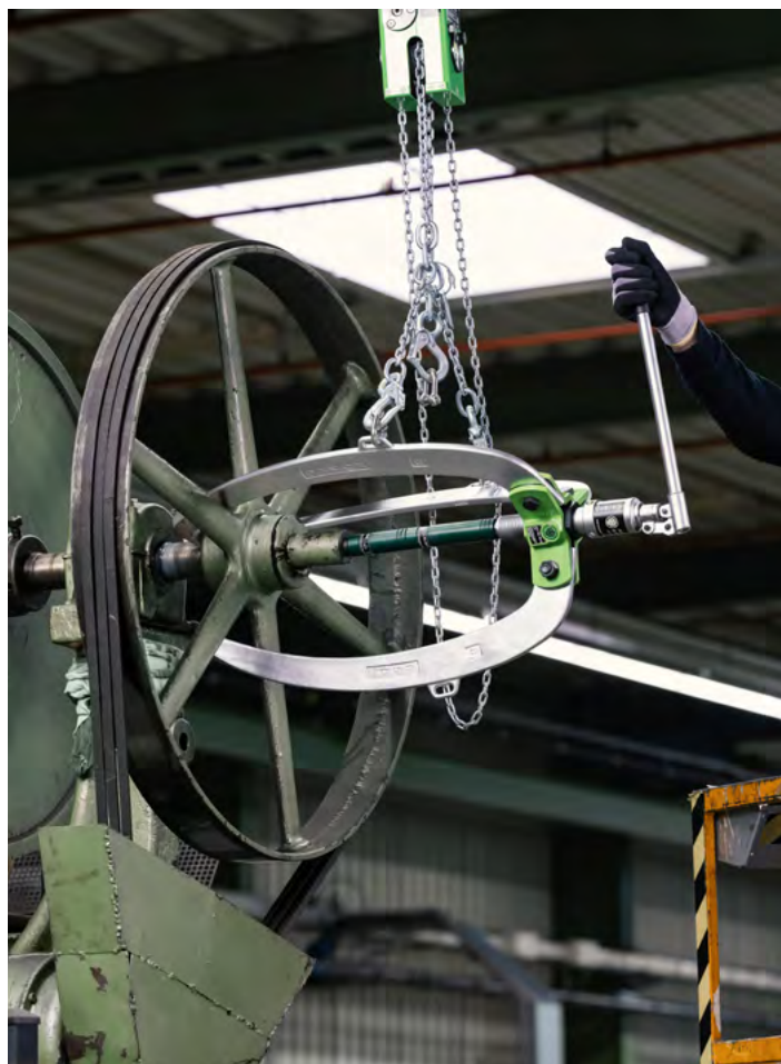
Estrazione di una puleggia con il 45-8 con mandrino idraulico.
