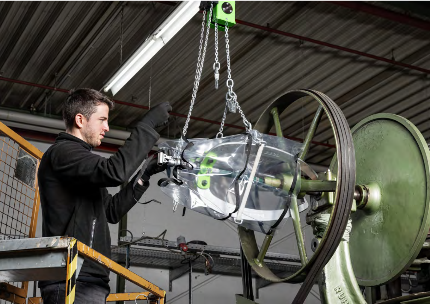
La copertura di sicurezza UFP offre sicurezza durante l'estrazione di una puleggia da una pressa.
