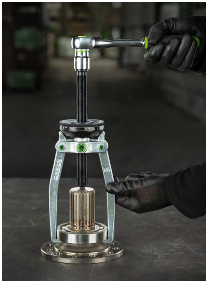
Estrazione esterna di un cuscinetto a sfere da un albero motore.
