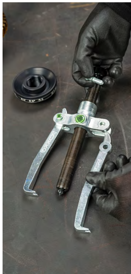
Ruotare le gambe dell'estrattore.
