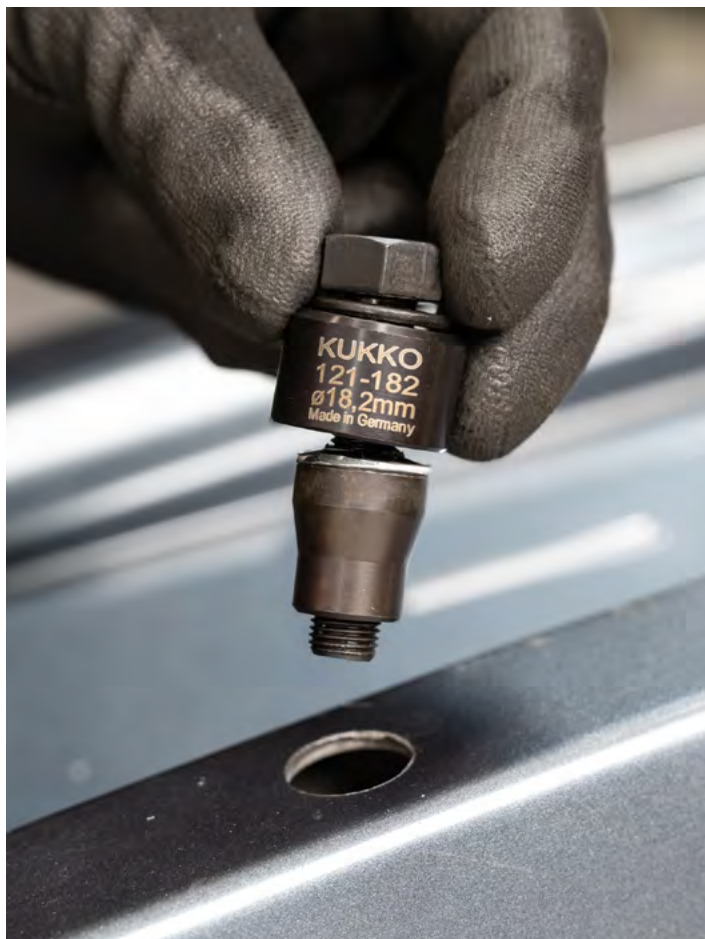
Il alesaggi 121-182 viene inserito nel foro precedentemente forato.
