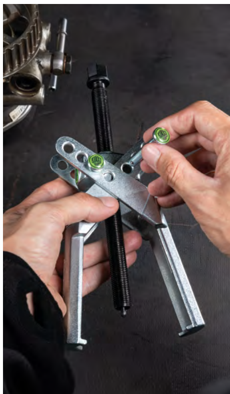
Spine di sicurezza rimovibili manualmente.
