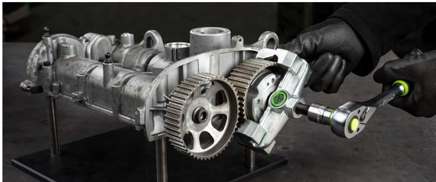
Processo di estrazione di un ingranaggio dell'albero a camme con l'118-0 utilizzando un'artiglio a unghia singola.
