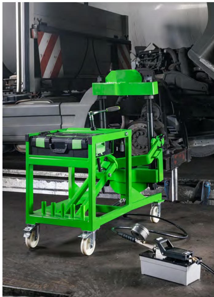
La pressa idraulica per perni a snodo "AXLE" Y-AP-75 è pronta per l'uso su un LKW.
