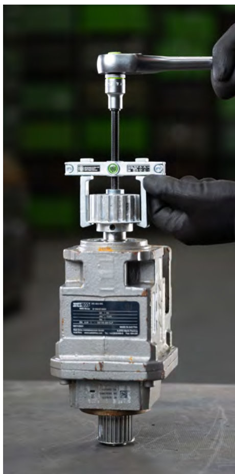
Estrazione di una puleggia da un ingranaggio di una macchina con il 110-02.
