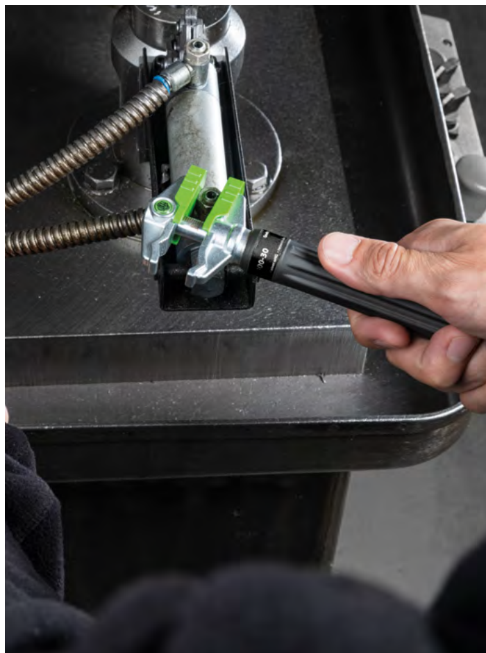
L'Europeo 1900-30 durante il serraggio o l'allentamento di un dado su una macchina.
