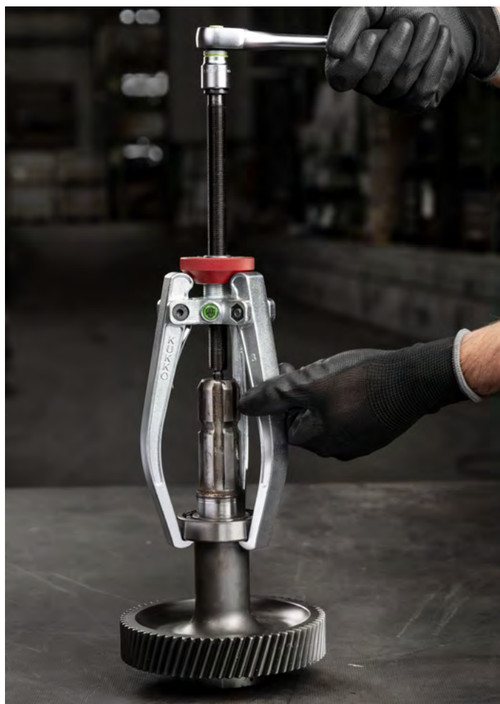
L'estrattore a 3 bracci per cuscinetti a sfera 113-3 con zigrino conico durante l'estrazione di un cuscinetto a sfera su un cambio.
