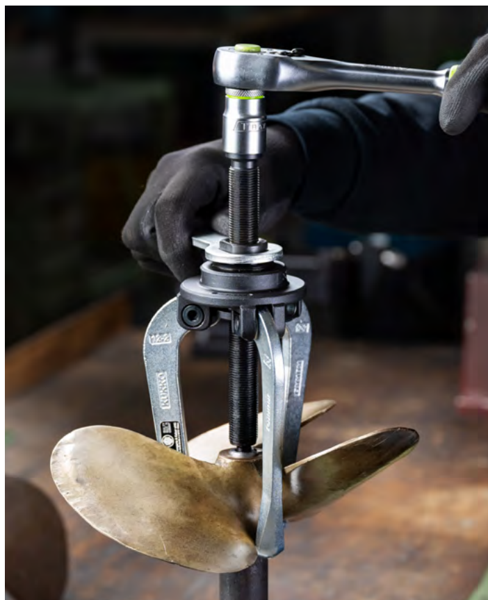
Smontaggio di un'elica con il 12-2.
