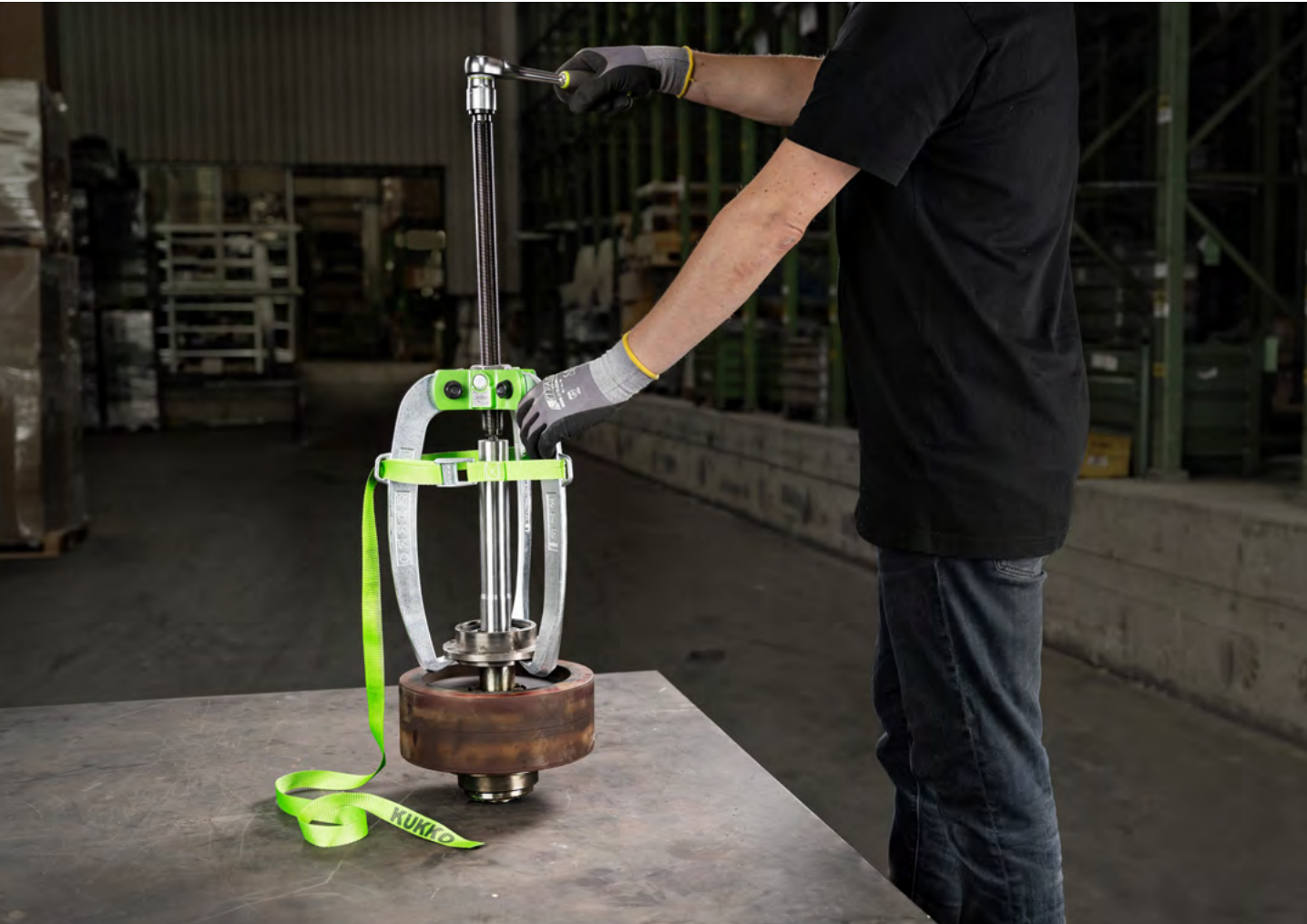
La cinghia di tensione USB-1 protegge un estrattore industriale 3 bracci durante l'estrazione.
