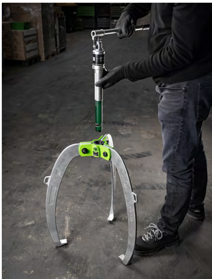
Inserimento della vite di pressione idraulica a grasso.
