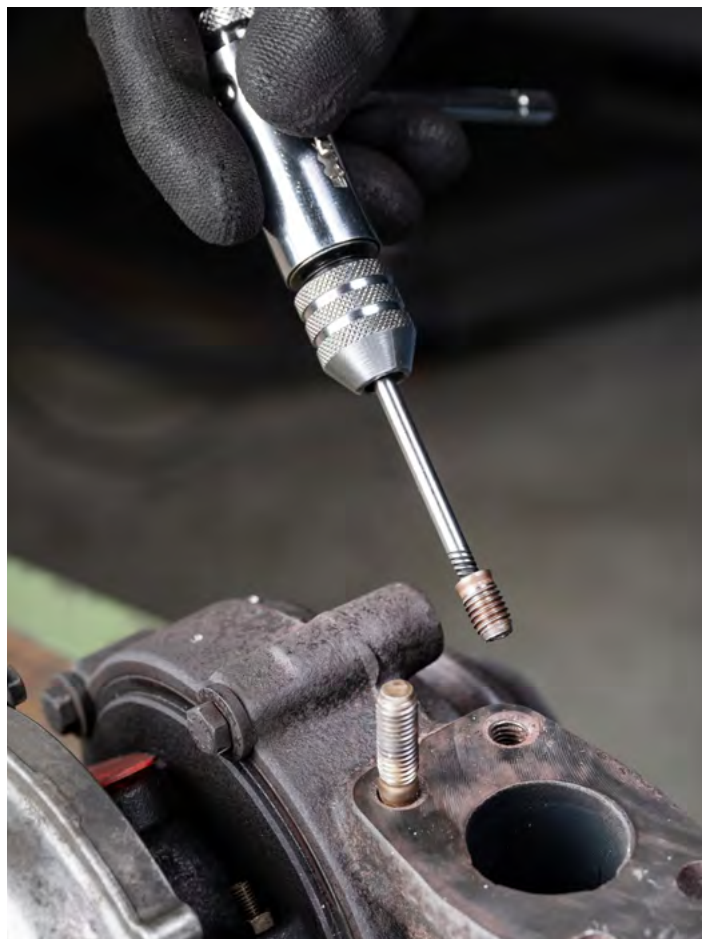
Un cacciavite dal set di cacciaviti 49-A ha rimosso in modo sicuro una vite.
