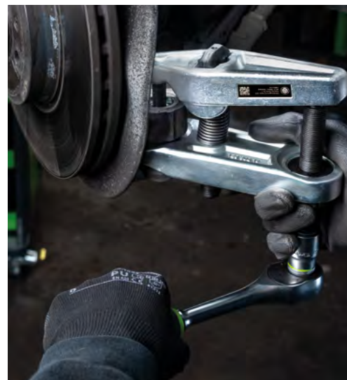
L'estrattore per snodi sferici 129-3 durante l'estrazione di un pomello della barra di accoppiamento in un'officina.
