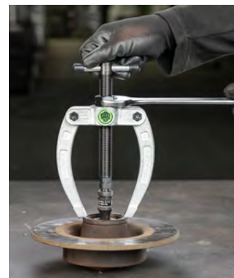
Estrattore interno con controspunti.
