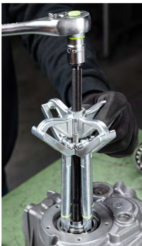
Smontaggio dei cuscinetti a sfera con il 70-K.
