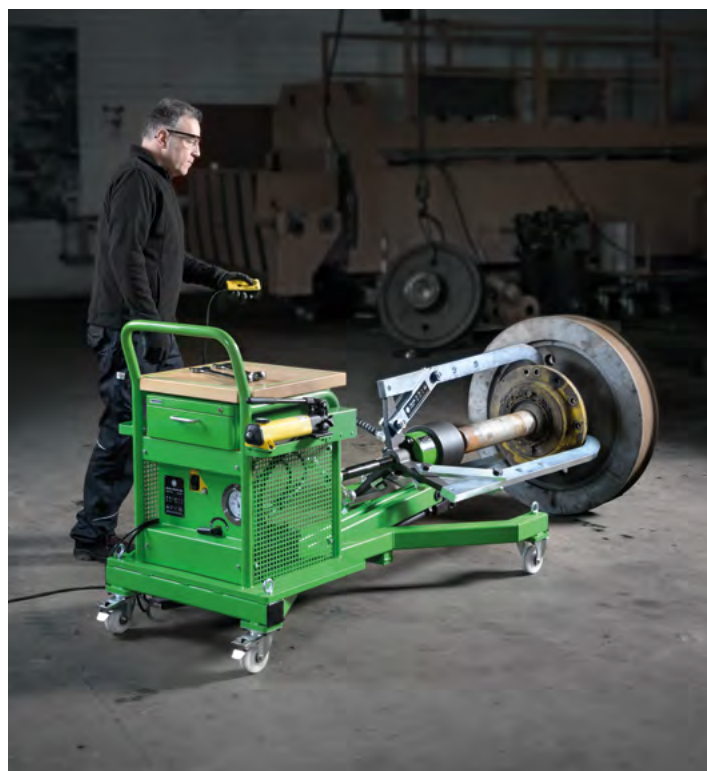
Il Mobile estrattore idraulico "GOLIATH" Goliath-556 durante l'estrazione di un cuscinetto a sfera bloccato di una gru.
