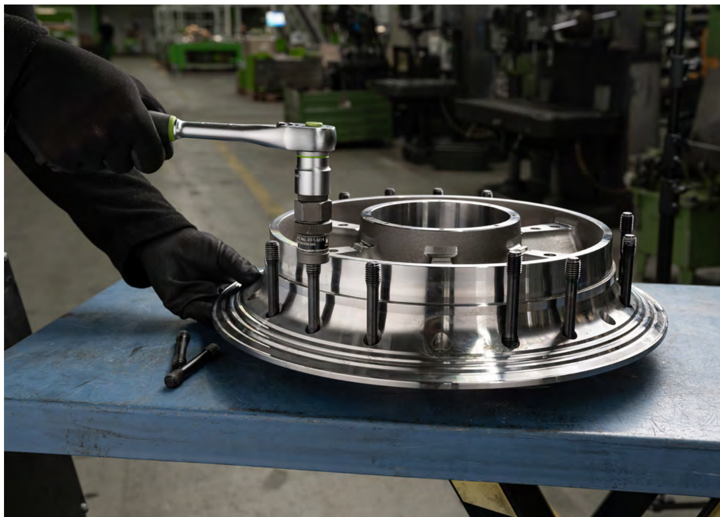
Svitare un prigioniero dalla ruota di una tramvia (serie 53).
