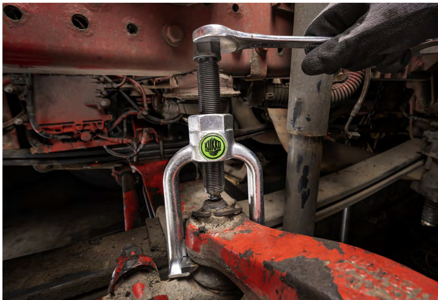
Il estrattore per giunti sferici 128-60 durante l'estrazione di una testa del tirante su una tiranteria.
