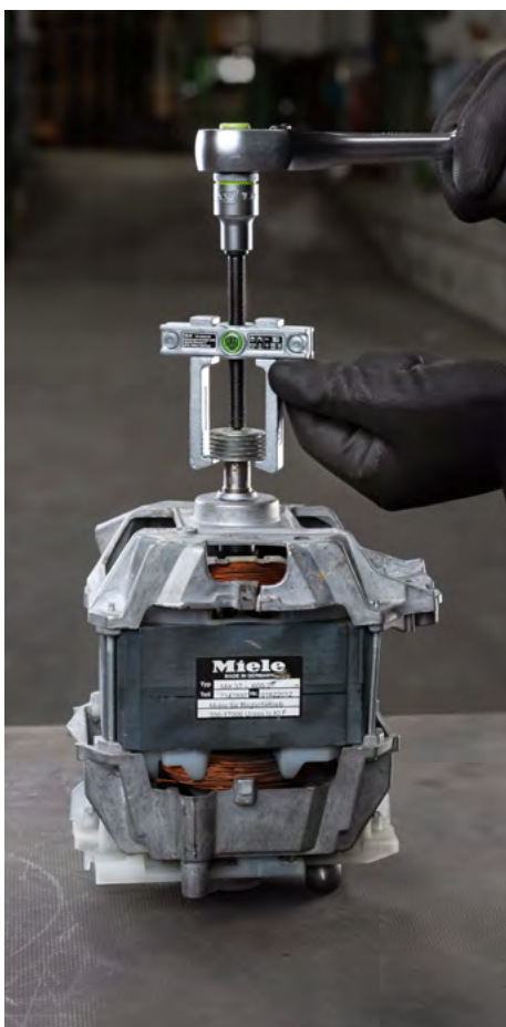
Estrarre una puleggia da un motore della lavatrice con il 110-01.
