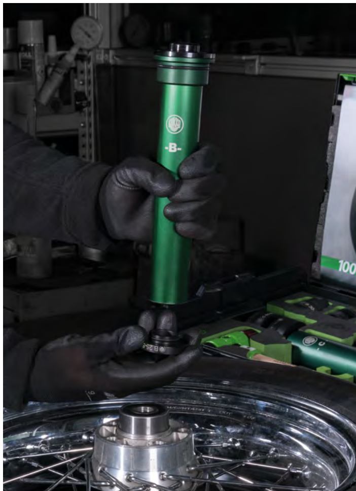
Inserimento dell'anello ad impatto appropriato nel tubo d'urto quando si utilizza un set K-71.
