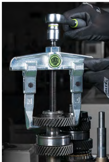
Estrazione di una ruota dentata del cambio con il 20-10.
