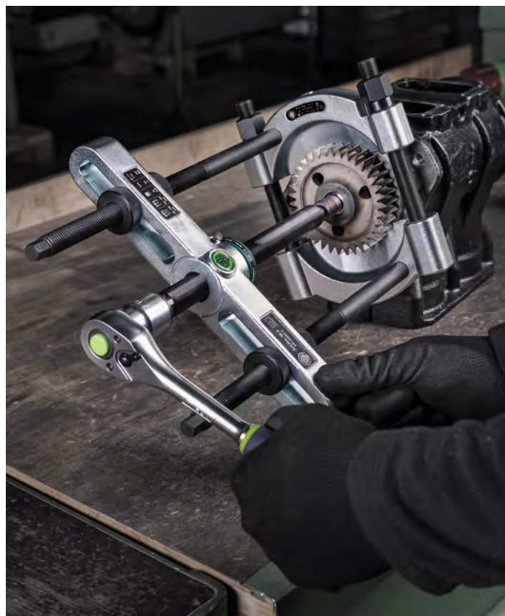
Estrarre una ruota dentata del cambio.
