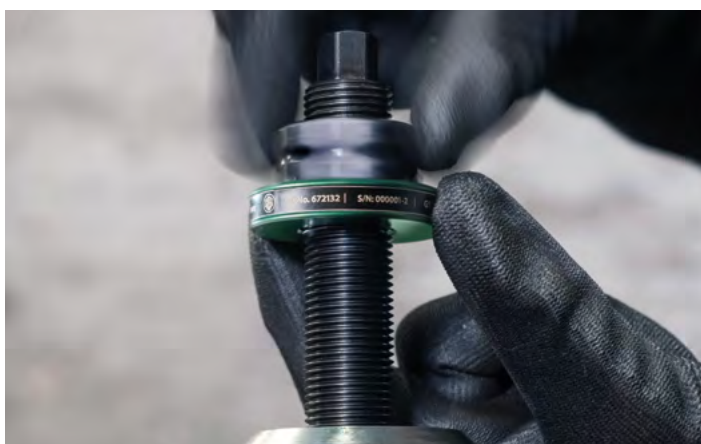
Il Power Nut viene avvitato sul mandrino.
