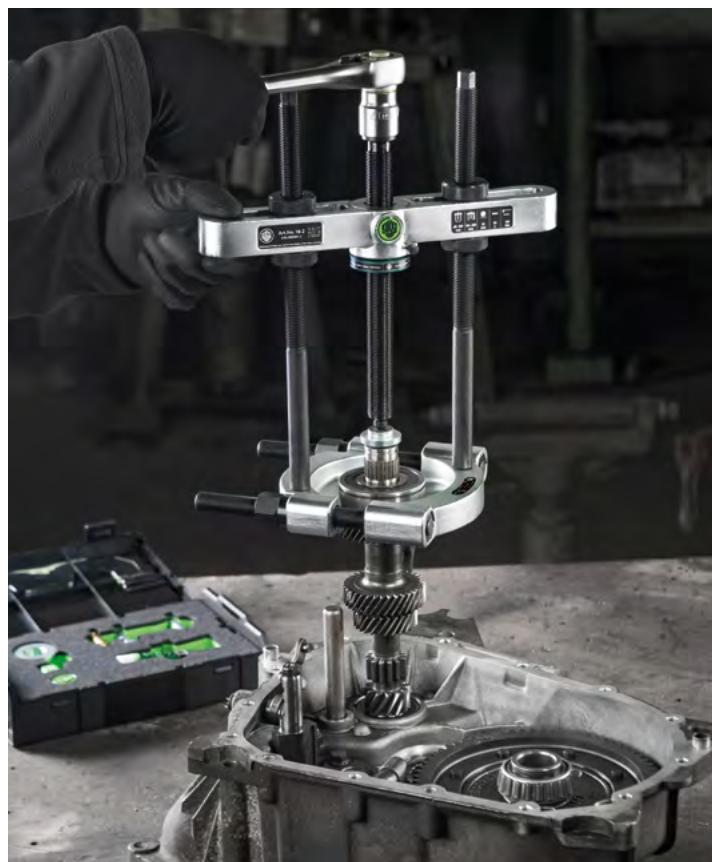
Estrarre un cuscinetti da un albero di trasmissione.
