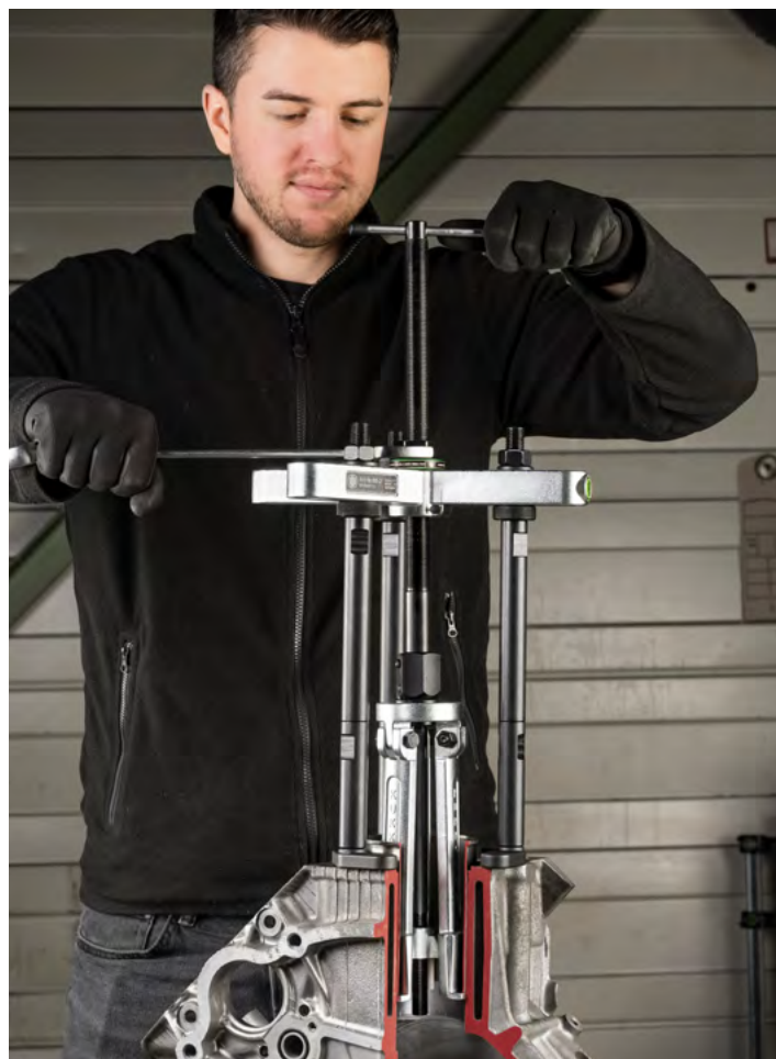
Uno sguardo all'interno durante l'estrazione di una boccola cilindrica.
