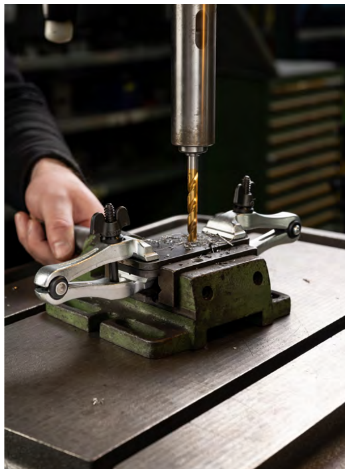
Due morsetti a mano 101-100 quando si serrano più pezzi per lavori di foratura.
