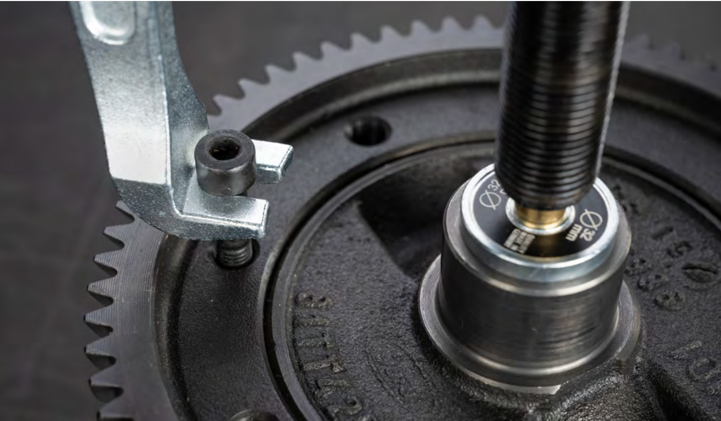
Entrambi le foto mostrano il processo di estrazione di un ingranaggio dell'albero a camme con il 118-0 utilizzando gli artigli a unghia.
