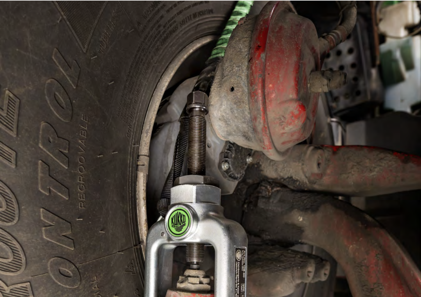
Le protezioni anti-caduta della serie 660 offrono protezione contro gli incidenti e i danni quando l'estrattore cade.
