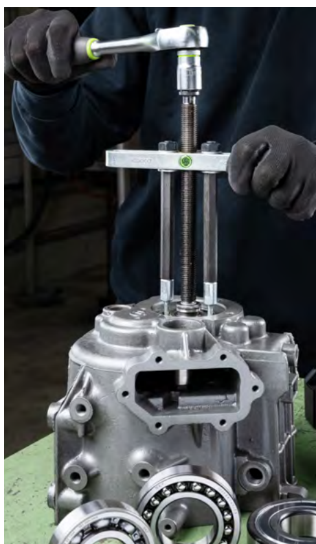
Smontaggio del cuscinetto a sfera con il 69-A.
