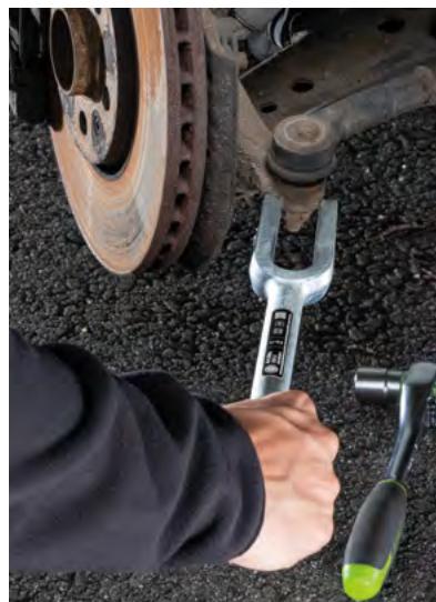
Separato di un braccio oscillante dalla sospensione della ruota.
