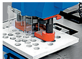
Stazione di punzonatura
