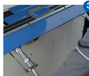
Fase 3: è possibile impostare l'angolo di piegatura corretto usando il dispositivo di controllo angolo. Eseguire la piegatura. L'adeguamento per altri procedimenti di curvatura viene eseguito con pochi movimenti
