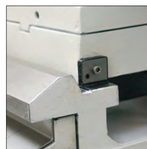
Geometria slitta longitudinale Ottimizzata per il massimo assorbimento delle forze
