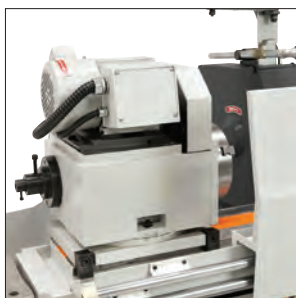
Piastra di serraggio La testa del mandrino può essere ruotata da 0° a 90° per operazioni coniche
