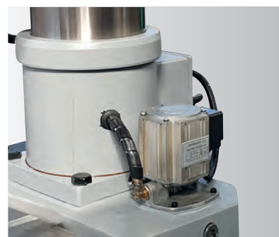
Impianto di refrigerazione
