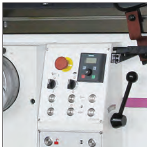
Comando inverter posizionato nel quadro comandi principale
