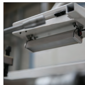
Lampada a LED Integrata nel protezione trucioli
