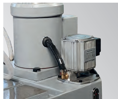
Impianto di refrigerazione
