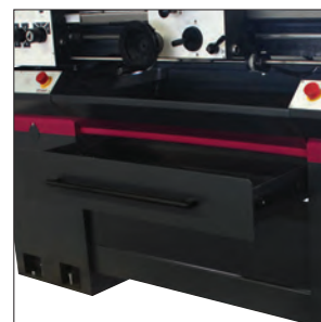
Vasca raccolta trucioli Estraibile montata su guide
