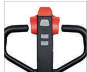
Comodo controllo di velocità, direzione di marcia e frenata tramite interruttori a bilanciere di facile utilizzo. Pulsanti grandi e facilmente accessibili per alzare e abbassare forcella, clacson
