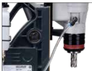
Lubrificazione interna automatica Il liquido refrigerante viene convogliato direttamente alla punta carotatrice senza spreco e migliorando la durata degli utensili e le loro prestazioni In assenza di liquido refrigerante il trapano si blocca impedendo così il surriscaldamento e l'usura dell'utensile
