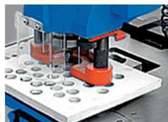
Stazione di punzonatura
