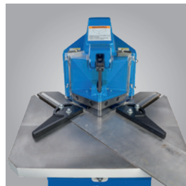
Tavolo con fermi per coltello inferiore
