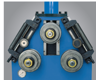
Su richiesta: rulli di allineamento laterali per sezione angolare
