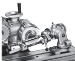
Affilatura dell'imbocco conico di un maschio Grinding the tapered point of a tap
