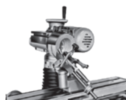
Affilatura di una punta elicoidale Grinding a twist drill
