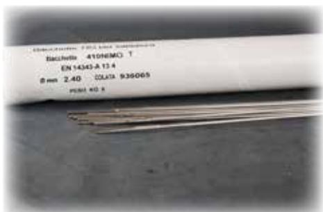
Il metallo d'apporto 410 NiMo è utilizzato per la saldatura dei laminati in acciai inox UNS S41500, degli acc. inox fusi tipo CA-6NM (UNS J91540) ed altri similari della serie 13Cr4NiMo.
