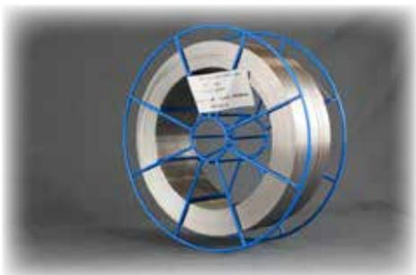
Il metallo d'apporto SIDER 307Si è usato principalmente per le saldature fra acciai dissimili, con moderato carico di rottura e buona resistenza alle cricche, come l'acciaio austenitico al manganese e l'acciaio al C.
