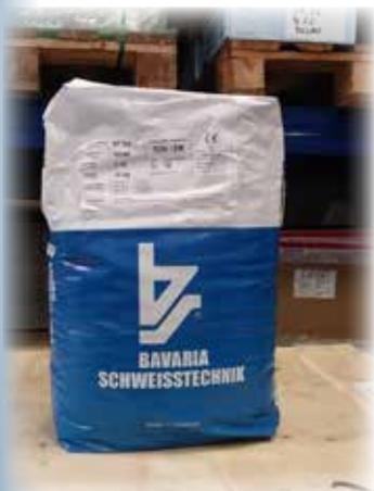
Flusso agglomerato alluminato-rutilico per la saldatura di acciai comuni al carbonio e basso legati con limite di snervamento fino a 355 N/mm<sup>2</sup> e con spessore <25 mm. in combinazione con fili tipo PITTARC S1, S2, S2Mo e S2Cr1Mo.
