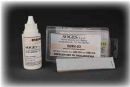
Con il RILEVATORE DI MOLIBDENO è possibile verificare in tempi estremamente rapidi la presenza o meno di Molibdeno in un determinato tipo di acciaio. La presenza di tale elemento distingue l'acciaio AISI 316 (molibdeno: 2-3%) dall' AISI 304 (molibdeno: assente). Con un flacone è possibile eseguire circa 100 prove.
