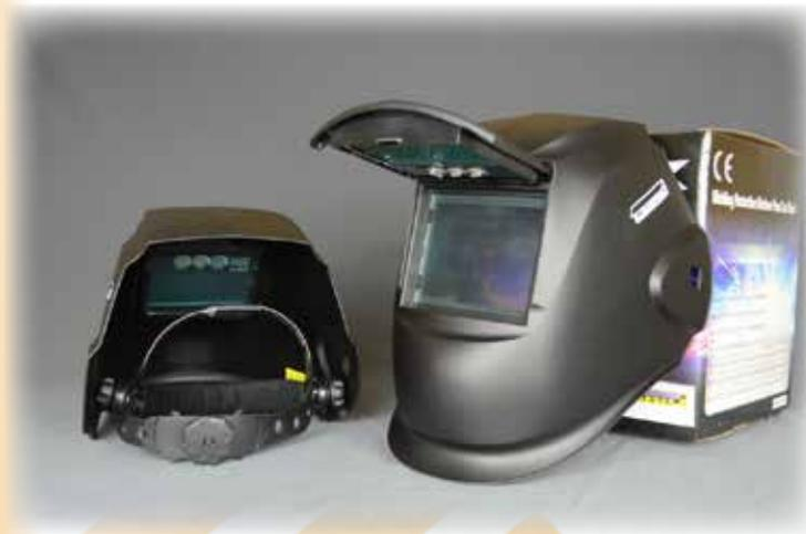
Dotata del nuovo dispositivo di ribaltamento del filtro, affianca il modello GHOST nella fascia delle maschere economiche di casa Soges, arricchendola di nuove funzionalità. L'ultra collaudato filtro ADF e la possibilità di escludere l'oscuramento con un semplice gesto, consentono al saldatore di fruire della sola posizione trasparente per le operazioni di molatura e finitura.
